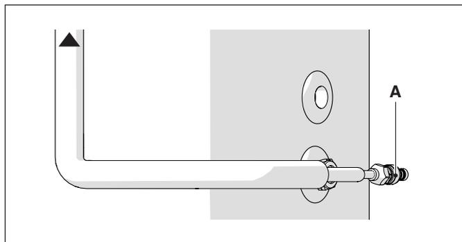
⚠ Se si sono utilizzate delle tubazioni in rame e si è eseguita una brasatura forte è necessario lavare l'impianto dai residui del fondente di brasatura. Successivamente eseguire la prova di tenuta.
