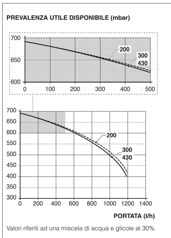
La velocità del circolatore è controllata da segnale PWM e varia in funzione al salto termico tra collettori solari e accumulò. Porre attenzione alle perdite di carico complessive del sistema (scambiatore, collettori solari e tubazioni) alle condizioni di portata massima prevista.
