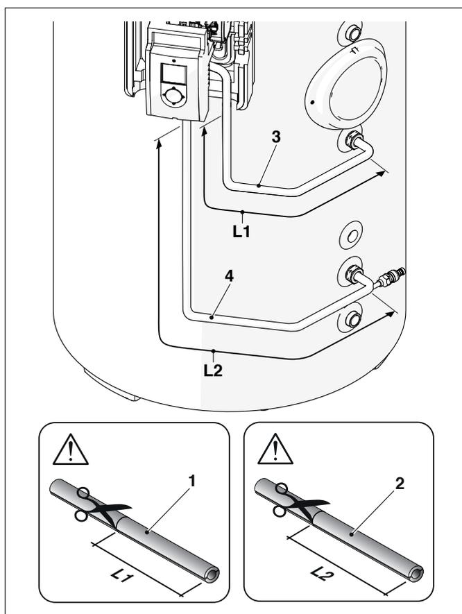
Rimuovere la pellicola adesiva (5) e applicare i due isolamenti (1-2) sulle tubazioni, con la giunzione posizionata nella parte posteriore.
