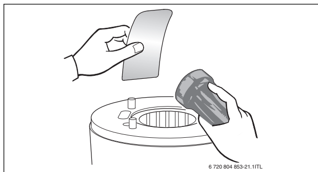
Fig. 51 Controllo della presenza di residui nello scambiatore primario
