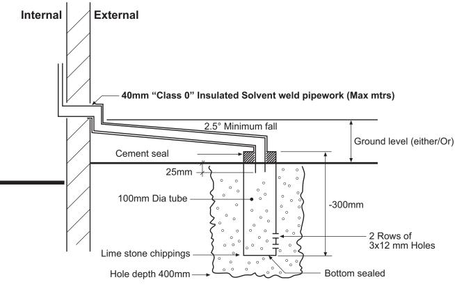
fig. 30 - Condensate drain
