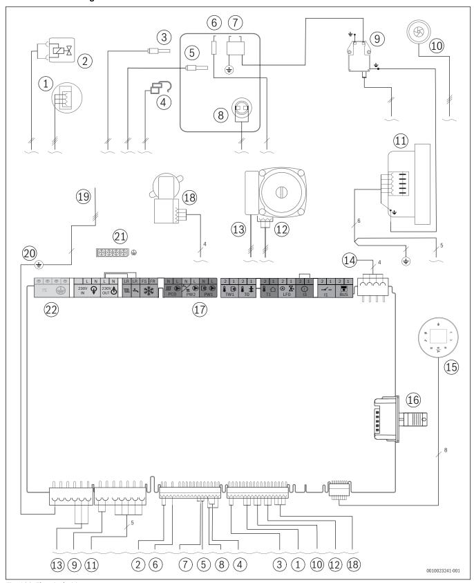
Fig. 108 Electrical wiring
