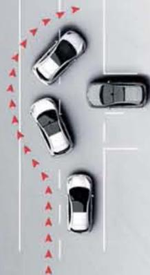
**ABS.** In caso di frenate brusche ed energiche, il sistema ABS evita il bloccaggio delle ruote e ti consente di mantenere la situazione sotto controllo.
