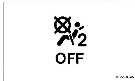
Spia di stato dell'airbag passeggero anteriore <OFF>
