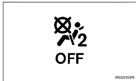
Spia di stato dell'airbag passeggero anteriore <OFF>
