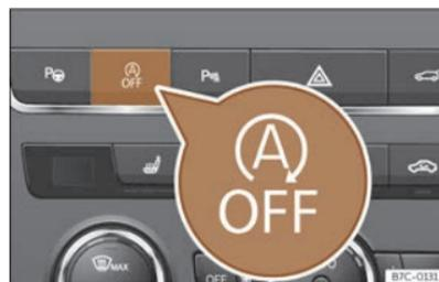
**Fig. 90** Console centrale: tasto del sistema Start/Stop.
