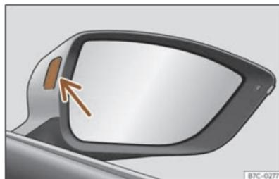
**Fig. 123** Spia di controllo assistente al cambio corsia.
