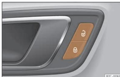
**Fig. 48** Sulla porta del conducente: pulsante della chiusura centralizzata.
