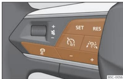
**Fig. 121** Lato sinistro del volante multifunzione.
