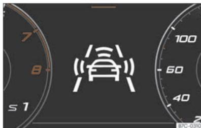
**Fig. 116** Sul display del quadro strumenti: Indicatori di preavviso.
