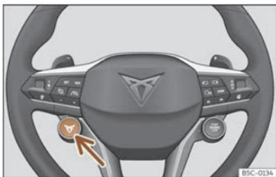
**Fig. 96** Volante multifunzione: tasto per modificare il profilo di guida.
