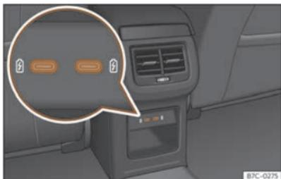
**Fig. 154** Parte posteriore della consolle centrale: connettori USB con funzione di presa di corrente.
