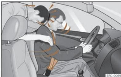
**Fig. 17** Se non indossa la cintura, il passeggero seduto sul sedile posteriore viene scagliato in avanti, colpendo il conducente (che invece indossa la cintura).
