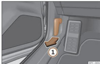
**Fig. 197** Leva di sblocco nel vano piedi del lato conducente.
