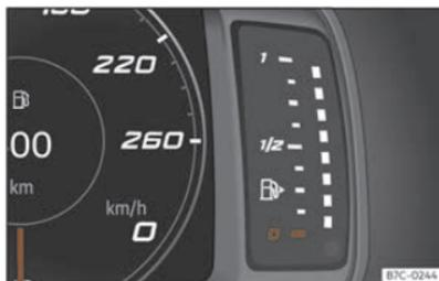
Fig. 2 Indicatore del livello del carburante.
