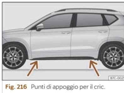
Fig. 216 Punti di appoggio per il cric.
