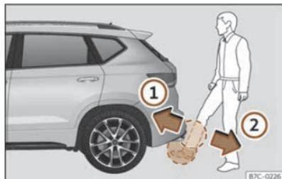
**Fig. 56** Portellone del bagagliaio con apertura controllata da sensore (Easy Open).
