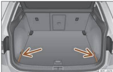
**Fig. 163** Nel bagagliaio: coperchi per riporre il ripiano.
