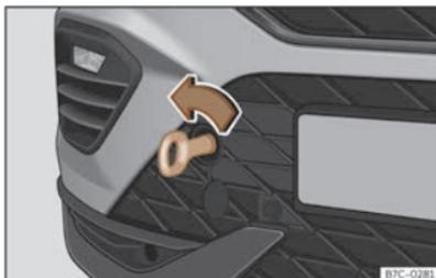
**Fig. 190** Paraurti anteriore destro: occhiello di traino avvitato.
