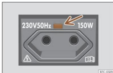
**Fig. 152** Nel lato sinistro del bagagliaio: presa di corrente da 230 volt.
