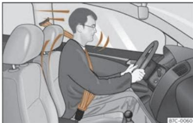
**Fig. 14** I conducenti che hanno la cintura di sicurezza correttamente allacciata non saranno proiettati fuori dal veicolo in caso di frenate repentine.
