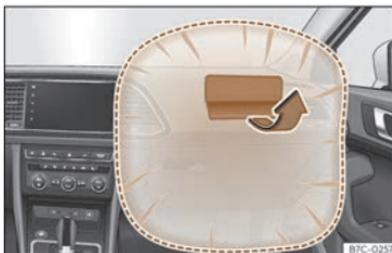
Fig. 23 Airbag del passeggero sul cruscotto.
