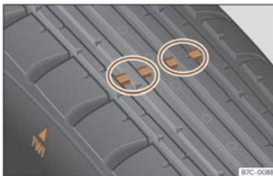
**Fig. 209** Profilo dello pneumatico: indicatori di usura.
