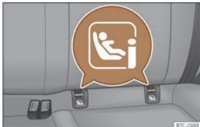
**Fig. 34** Sedile posteriore: posizione degli occhielli di fissaggio del sistema ISOFIX o i-Size.
