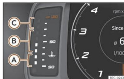
Fig. 3 Indicatore della temperatura del liquido di raffreddamento.
