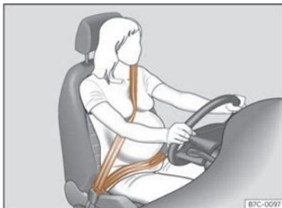
**Fig. 21** Posizione del nastro della cintura di sicurezza per donne in stato di gravidanza.
