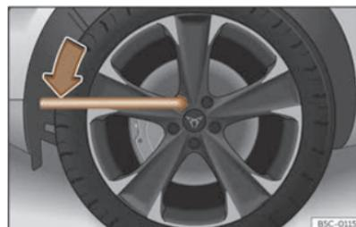
**Fig. 215** Cambio di una ruota: come allentare le viti delle ruote.
