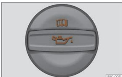
**Fig. 206** Tappo del bocchettone di rifornimento dell'olio motore, nel vano motore.
