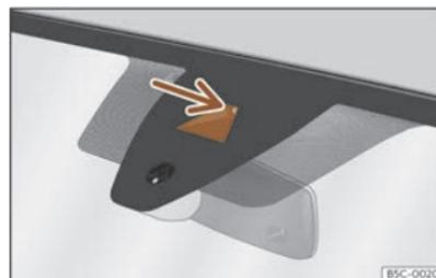
**Fig. 102** Nel parabrezza: area del campo visivo del dispositivo di assistenza per il mantenimento della corsia.
