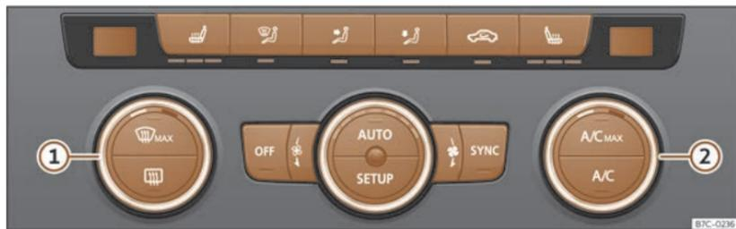
Fig. 85 Nella console centrale: comandi del Climatronic.
