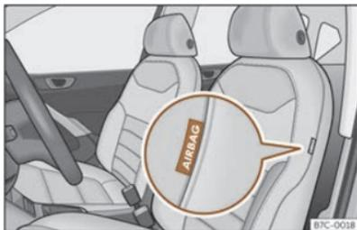
**Fig. 26** Airbag laterale all'interno del sedile del conducente.
