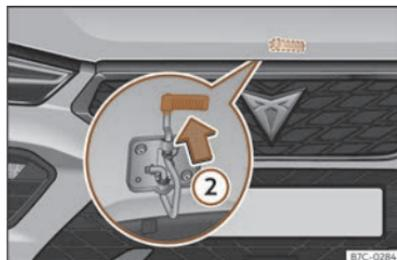
**Fig. 198** Leva sotto il cofano del vano motore.
