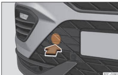
**Fig. 189** Sul lato destro del paraurti anteriore:staccare il coperchio.
