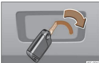
**Fig. 58** Particolare del bagagliaio: sblocco di emergenza.
