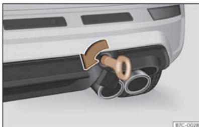
**Fig. 192** Sul lato destro del paraurti posteriore: occhiello di traino avvitato.
