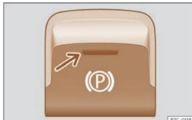
**Fig. 126** Nella parte inferiore della console centrale: tasto del freno di stazionamento elettronico.
