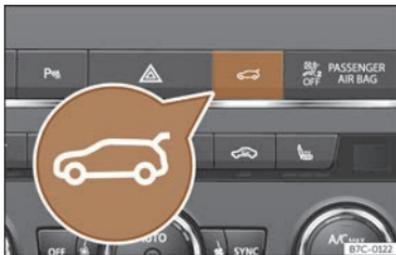
**Fig. 55** Consolle centrale: tasto per aprire e chiudere il portellone posteriore.
