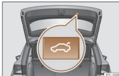
**Fig. 54** Portellone posteriore: tasto per chiudere il portellone.
