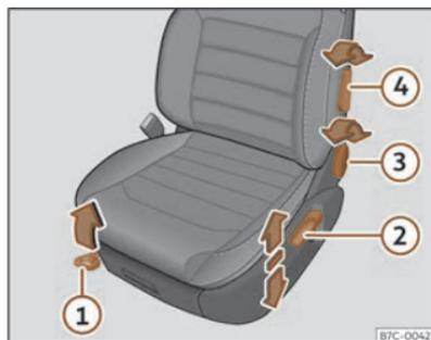
Fig. 66 Sedili anteriori: regolazione manuale del sedile.
