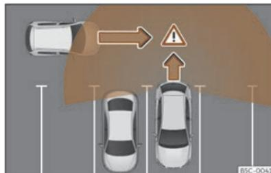
**Fig. 146** Rappresentazione schematica dell'assistente all'uscita dal parcheggio: zona vigilata intorno al veicolo che sta uscendo dal parcheggio.
