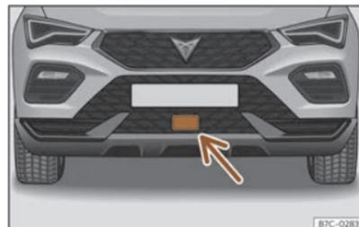
**Fig. 100** Sul paraurti anteriore: sensore radar.
