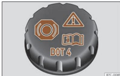
Fig. 201 Vano anteriore: tappo del serbatoio del liquido dei freni.
