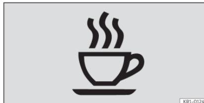
**Fig. 4** Sul display del quadro strumenti: Simbolo del sistema di monitoraggio della sonnolenza.
