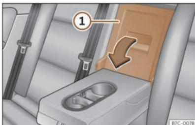
**Fig. 172** Sullo schienale del sedile posteriore: apertura della sponda.
