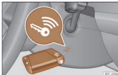
**Fig. 89** A destra del piantone dello sterzo: avviamento di emergenza.
