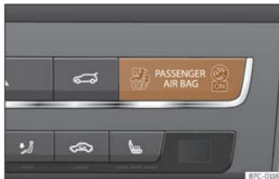
**Fig. 25** Cruscotto: spia di controllo della disattivazione dell'airbag del passeggero.
