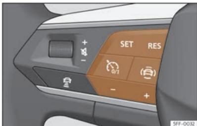
**Fig. 107** Nel volante multifunzione: tasti per gestire il limitatore di velocità.
