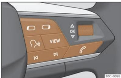
**Fig. 7** Lato destro del volante multifunzione: tasti per l'utilizzo dei menu e delle indicazioni informative del quadro strumenti (a seconda della versione).
