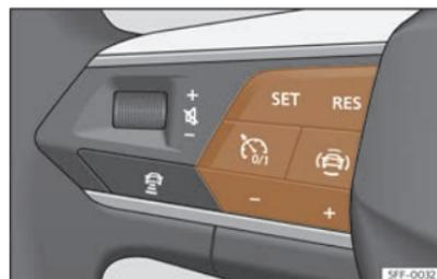
**Fig. 106** Sul volante multifunzione: tasti per gestire il regolatore di velocità.
