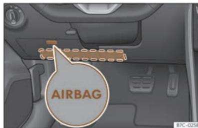
**Fig. 29** Sul lato del conducente: alloggiamento dell'airbag per le ginocchia.
