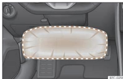
**Fig. 30** Sul lato del conducente: raggio d'azione dell'airbag per le ginocchia.
