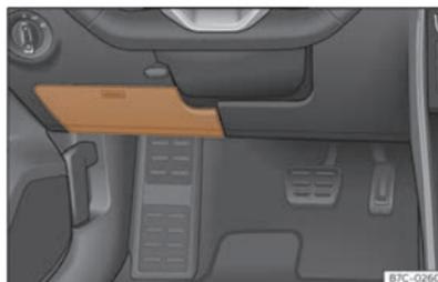
**Fig. 193** Sul cruscotto del lato del conducente: coperchio della scatola portafusibili.
