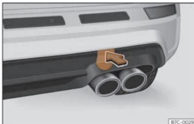
**Fig. 191** Sul lato destro del paraurti posteriore: rimuovere il coperchio.
