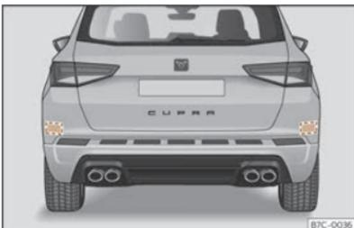
**Fig. 103** Veduta posteriore del veicolo: zone dei sensori radar.
