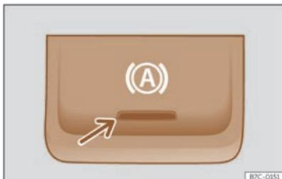
**Fig. 127** Nella parte inferiore della console centrale: tasto della funzione Auto Hold.
