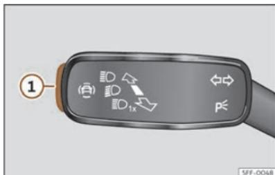
**Fig. 98** Sulla leva degli indicatori di direzione e degli abbaglianti: tasto per i sistemi di assistenza alla guida (a seconda della versione).
