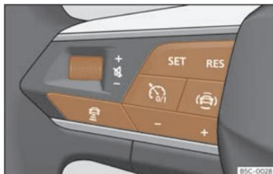
**Fig. 110** Sul volante multifunzione: tasti per gestire l'ACC.
