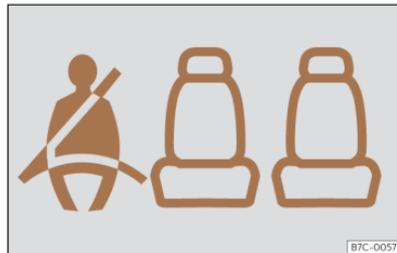
**Fig. 15** Quadro strumenti: indicazione dello stato delle cinture di sicurezza delle postazioni posteriori.
