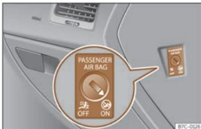
**Fig. 24** Interruttore a chiave per l'attivazione e la disattivazione dell'airbag del passeggero.
