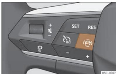
**Fig. 99** Lato sinistro del volante multifunzione: tasto per i sistemi di assistenza alla guida (a seconda della versione).
