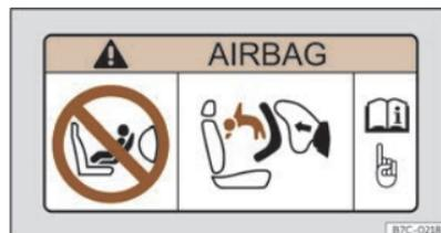
Fig. 32 Adesivo dell'airbag: nell'aletta parasole del lato passeggero.
