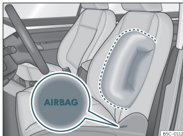
Fig. 25 Airbag laterale all'interno del sedile del conducente.
