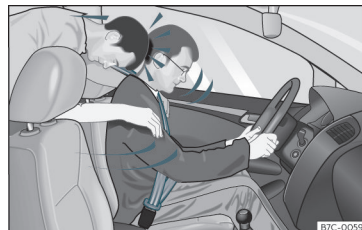
Fig. 12 Se non indossa la cintura, il passeggero seduto sul sedile posteriore viene scagliato in avanti, colpendo il conducente (che invece indossa la cintura).
