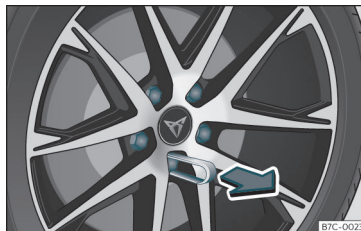
Fig. 39 Ruota: viti della ruota con tappi.
