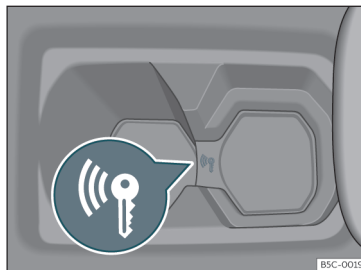
Fig. 154 Sulla console centrale: avviamento di emergenza.
