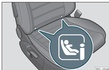
Fig. 32 Sedile passeggero anteriore: occhielli di fissaggio ISOFIX/iSize.
