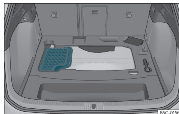
Fig. 222 Alloggiamento della batteria nel bagagliaio
