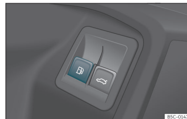
Fig. 209 Porta del conducente: sblocco dello sportellino del serbatoio.
