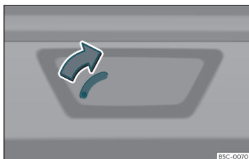
Fig. 90 Particolare del bagagliaio: sblocco di emergenza (Leon Sportstourer).
