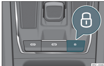
Fig. 79 Sulla console centrale: interruttore della chiusura centralizzata
