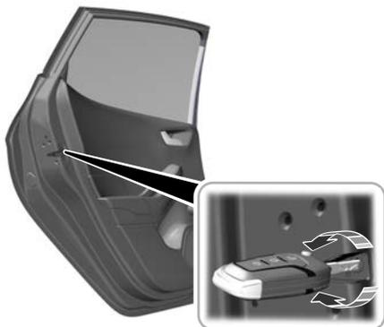
Il blocco sicurezza bambini si trova sul bordo posteriore di ciascuna portiera posteriore. Occorre attivare il blocco sicurezza bambini separatamente su ciascuna portiera.
