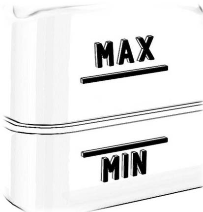
A temperatura ambiente, assicurarsi che il livello del liquido di raffreddamento sia compreso tra i contrassegni **MIN** e **MAX** presenti sul serbatoio del liquido stesso. Se il livello del liquido di raffreddamento si trova in corrispondenza o al di sotto del contrassegno minimo, rabboccare immediatamente con liquido di raffreddamento.
