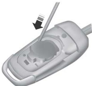
5. Inserire un cacciavite nella posizione indicata in figura per sganciare la batteria.
