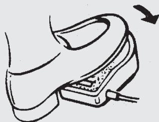
Con il reostato potete controllare la velocità di cucitura. Più premete sul reostato, più la macchina cuce velocemente.
