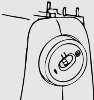
6. Spostate il bottone del volantino sul simbolo dell'ago per attivare il trascinamento della macchina.
