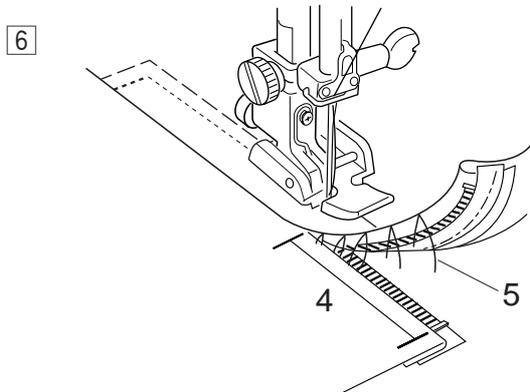
6 Cucire prendendo insieme l'indumento e il nastro della cerniera, guidando i denti lungo il bordo laterale del piedino.
