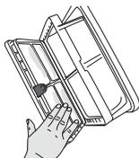
Qualora si veda uno strato sul filtro che può bloccare il filtro, togliere lo strato lavando con acqua, quindi pulire. Asciugare il panno filtro in modo adeguato prima di sostituire il cassetto del filtro.
