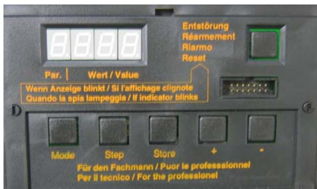
**PARA:** modo parametri (per cambiare i parametri)
