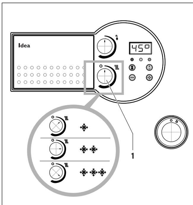
Fig. 4.6 Temperatura di mandata - Impostazione sulla caldaia
