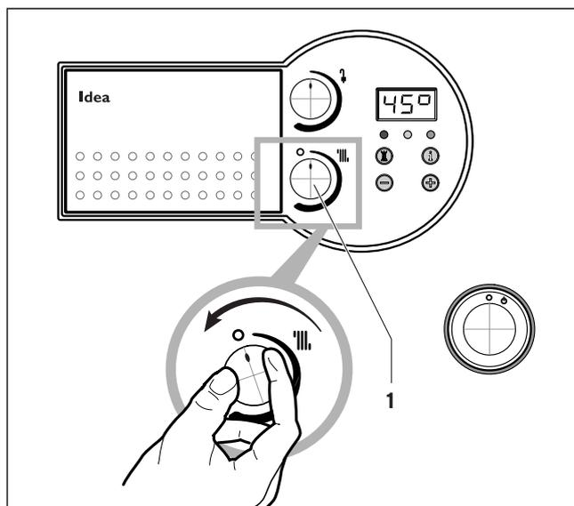
Fig. 4.7 Disattivazione della modalità di riscaldamento (modalità estiva)
