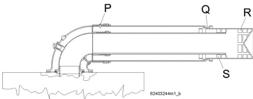
**Figura 39 - Corretta installazione del condotto coassiale**
