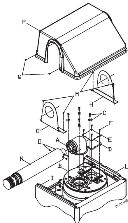
**Figura 38 - Installazione del sistema coassiale**
