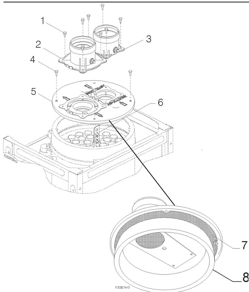
**Figura 50 - Smontaggio parte superiore scambiatore di calore**
