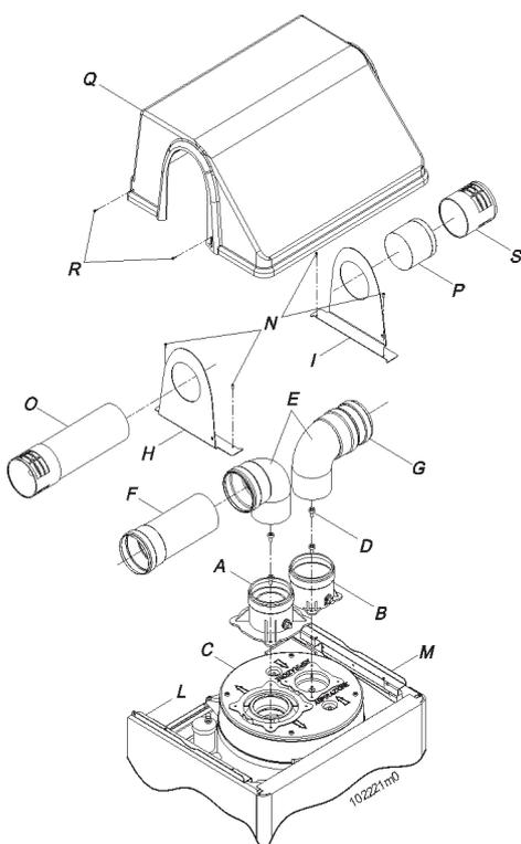
**Figura 30 - Installazione del sistema sdoppiato 80/80**
