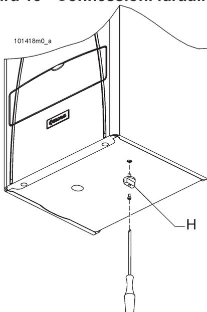
Figura 16 - Montaggio manopola rubinetto di carico
