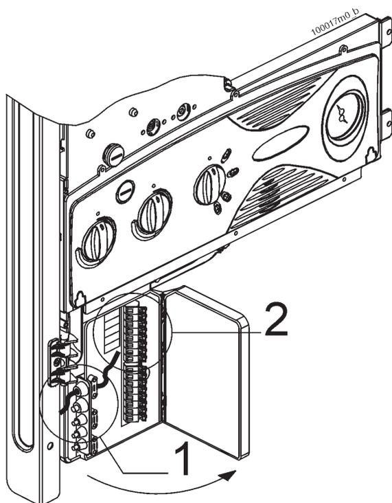
Figura 23 - Apertura box connessioni elettriche
