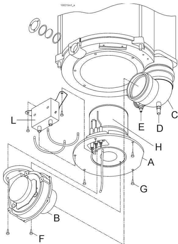
**Figura 51 - Smontaggio parte inferiore scambiatore di calore**
