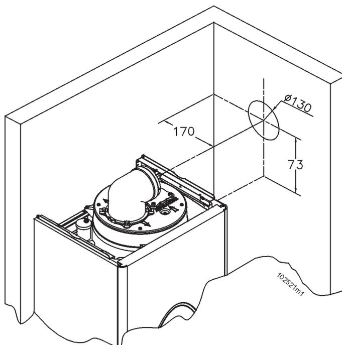
Figura 41 - Quote e interassi foro di preinstallazione scarico coassiale
