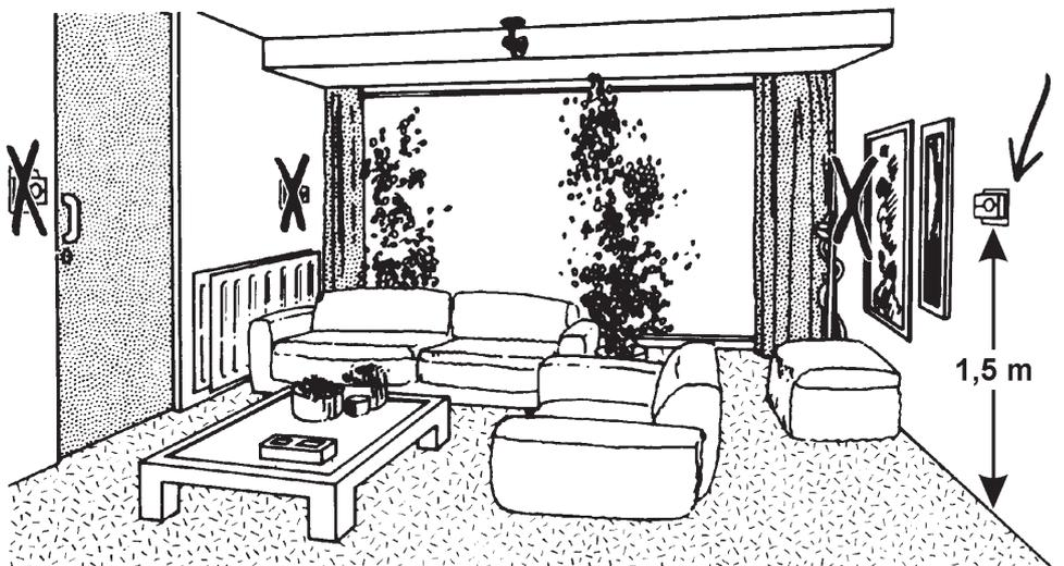
Figura 21 - Posizionamento corretto del termostato ambiente/cronotermostato
