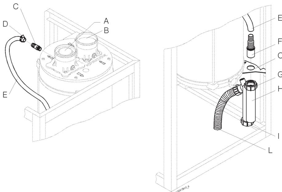
**Figura 42 - Esempi di installazione dello scarico condensa integrato nella caldaia**
