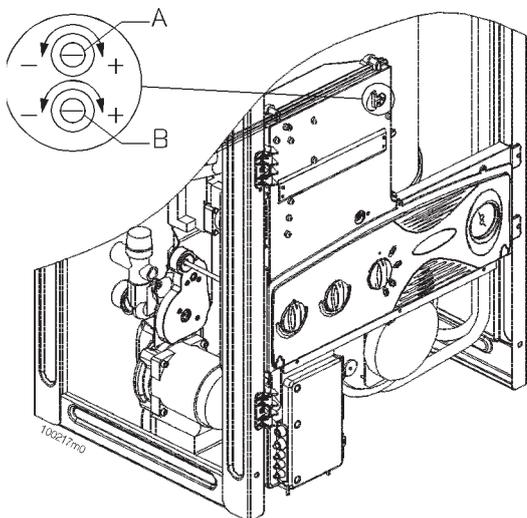
Figura 47 - Regolatori di massima potenza (A) e minima potenza (B)
