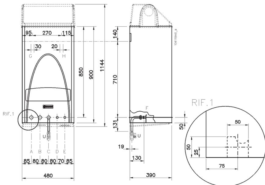
**Figura 6 - Dimensioni caldaia e interassi attacchi**
