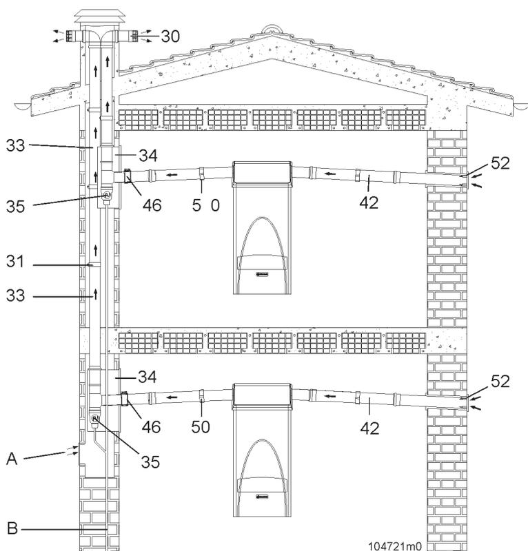
Figura 35 - Esempio di scarico sdoppiato con raccolta di condensa in camino.
