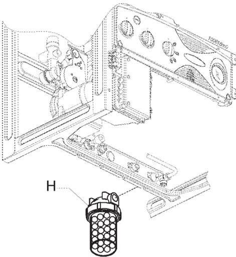
Figura 13 - Decalcificatore a polifosfati
