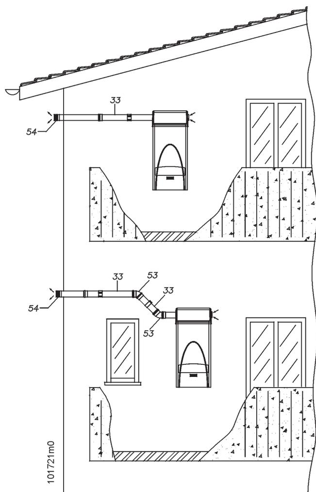
Figura 34 - Esempio di installazione scarico singolo.
