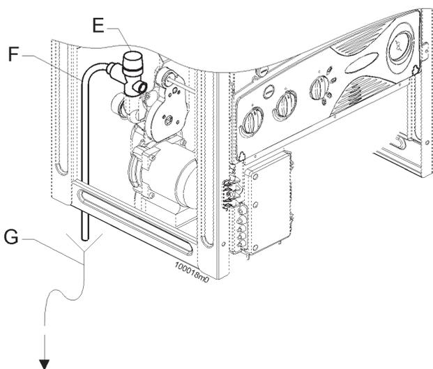
Figura 17 - Collegamento scarico valvola di sicurezza
