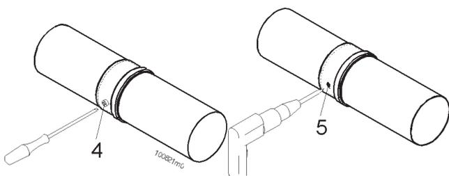
**Figura 32 - Fissaggio dei condotti di scarico ed aspirazione**
