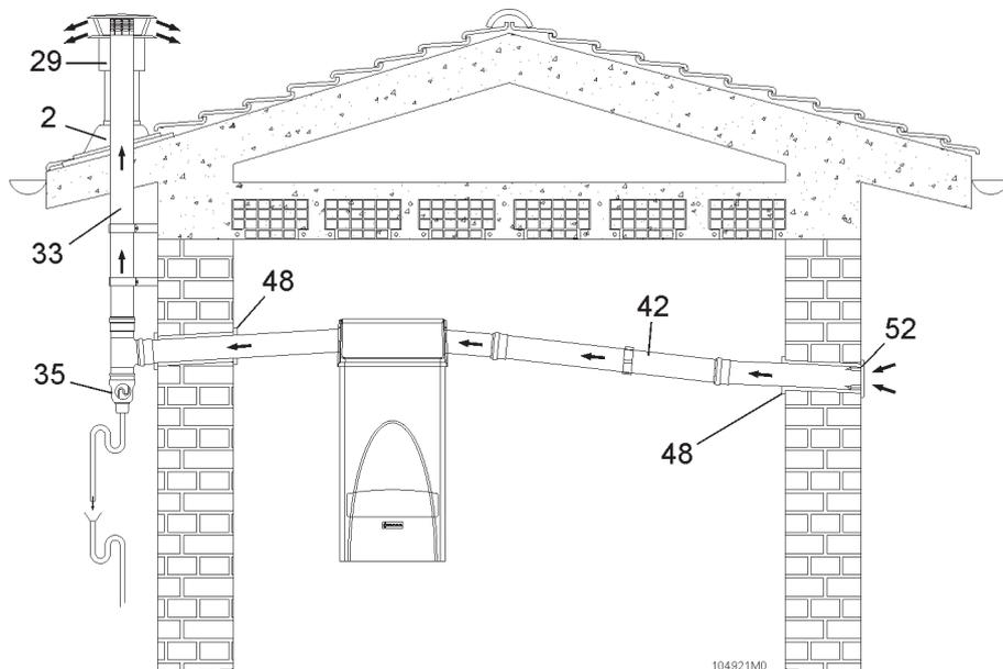
Figura 37 - Esempio di scarico su camino esterno ed aspirazione in parete
