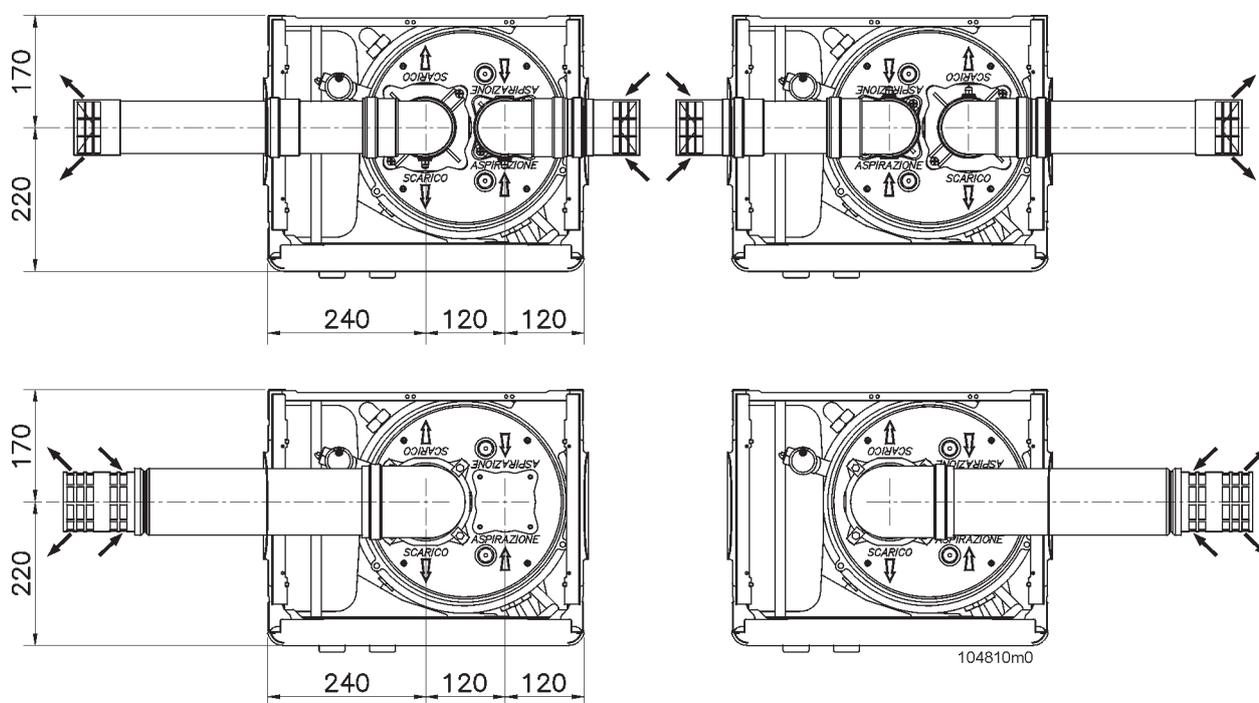
Figura 29 - Possibilità di rotazione dello scarico e della aspirazione con condotto separato e con condotto coassiale
