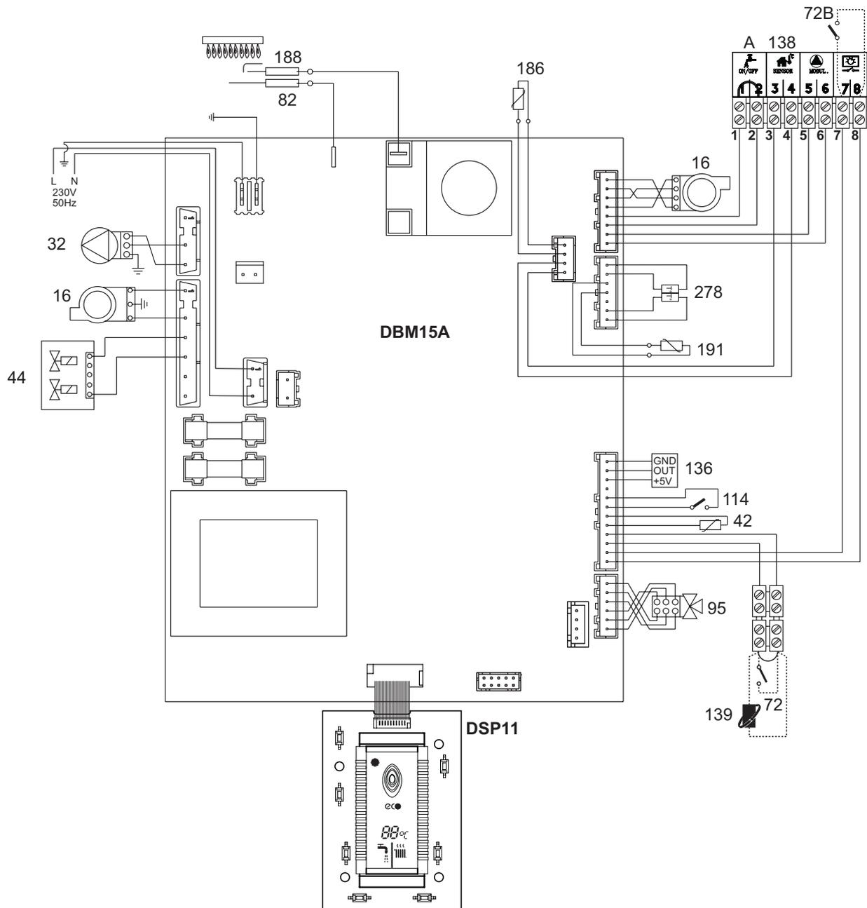
fig. 33 - Schema elettrico
