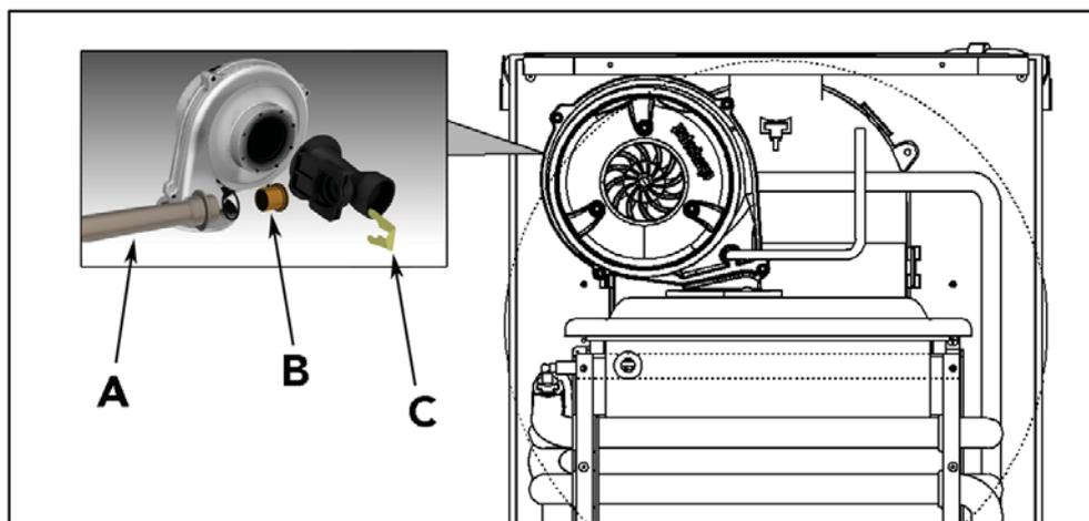
fig. 26 - Trasformazione gas
