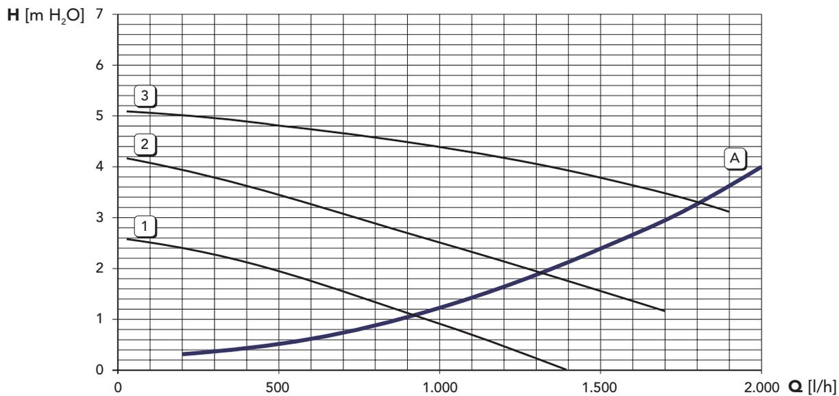
**A** Perdite di carico caldaia
