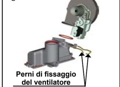
Perni di fissaggio del ventilatore
