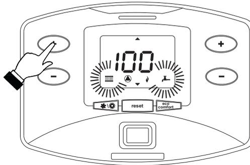
**fig. 40 - Modalità TEST (potenza riscaldamento = 100%)**
