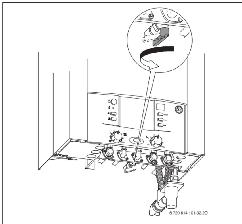
Fig. 3 Vista caldaia con piastra d'installazione, accessorio nr. 893/18
