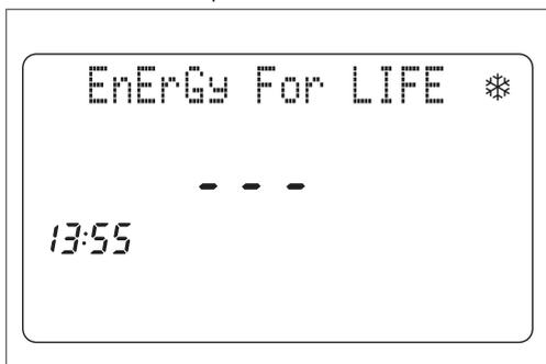
**Antigelo:** quando la temperatura dell'acqua di caldaia scende a 7°C si attiva il circolatore e, se necessario, il bruciatore alla minima potenza per riportare la temperatura dell'acqua a valori di sicurezza. S
