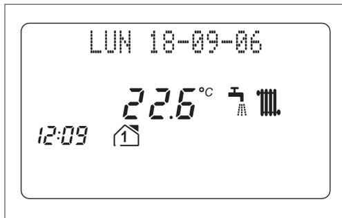
**⊖** Il pannello comandi viene configurato da fabbrica come **CRONOTERMOSTATO**, se si desidera un funzionamento come Termostato Ambiente è necessario chiedere al personale del Servizio Tecnico di Assistenza di impostarlo come tale.
