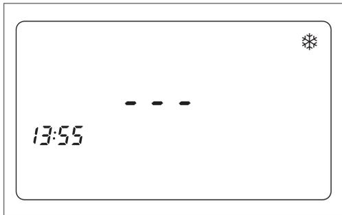
**Antigelo:** quando la temperatura dell'acqua di caldaia scende a 7°C si attiva il circolatore e, se necessario, il bruciatore alla minima potenza per riportare la temperatura dell'acqua a valori di sicurezza.
