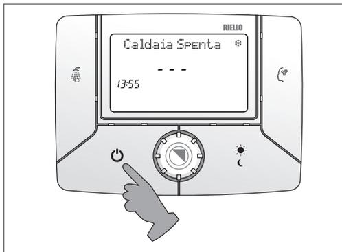
Restando attive l'alimentazione elettrica e quella del combustibile, la caldaia sarà protetta dal sistema antigelo.
