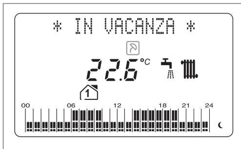
La funzione prevede il mantenimento continuo della caldaia alla temperatura T3. Durante questa funzione tutto il display rimane spento ad eccezione del simbolo vacanze e l'INDICATORE ALFANUMERICO che visualizza **"IN VACANZA"**.
