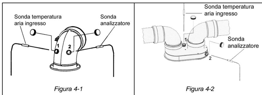
N.B. - Il mancato prelievo della temperatura dell'aria comburente al punto 1 riduce la lettura del rendimento totale della caldaia di  $1,5 \div 2$  punti.
