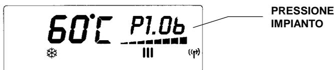
Quando la pressione è inferiore a quella richiesta (circa **P1.08**), occorre ripristinare il valore corretto. Per effettuare l'operazione occorre:
