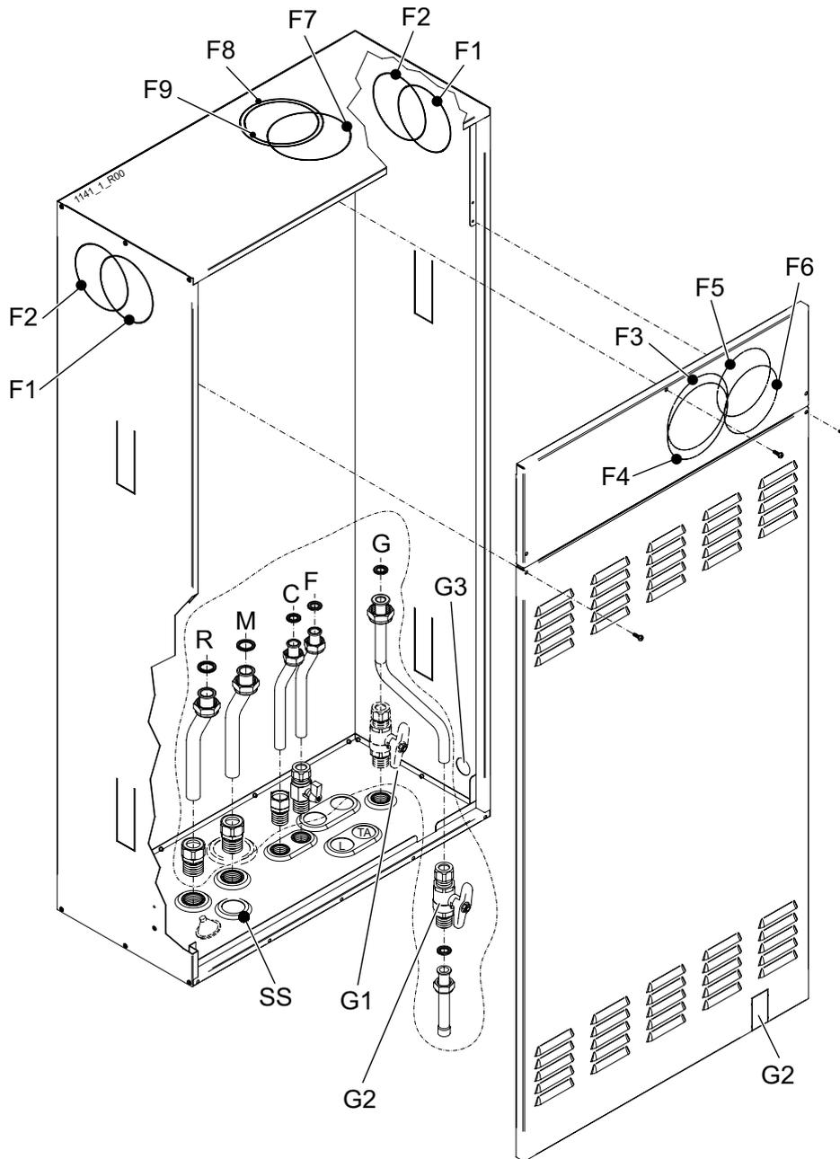
**F1, F4, F6, F7** Non utilizzati con questo modello di caldaia
