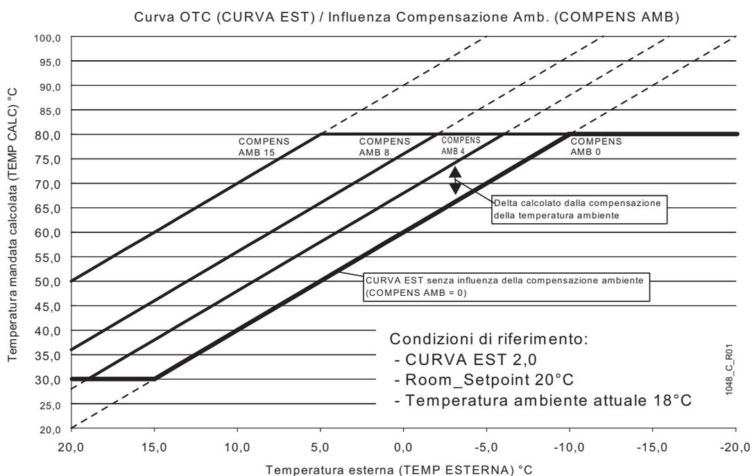
**COMPENS AMB:** Questo parametro è studiato per compensare il grado di isolamento termico dell'edificio. Esso influisce sulla termoregolazione degli ambienti, in particolare sulla temperatura di mandata: quando è impostato a 0, la temperatura di mandata all'impianto è quella calcolata dal Cronocomando.
