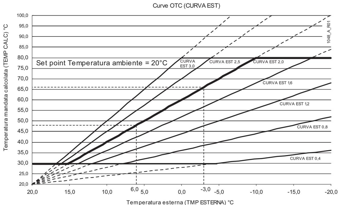
Più il clima della zona è rigido (ad esempio paesi nordici o alta montagna), più elevato dovrà essere il valore di questo parametro: la curva scelta sarà più ripida e la temperatura di mandata aumenterà più velocemente al diminuire della temperatura esterna. All'estremo opposto, il valore 0.0 del parametro *CURVA EST*, per il quale la curva nel grafico coincide con l'asse orizzontale, renderà di fatto ininfluenza la temperatura esterna.
