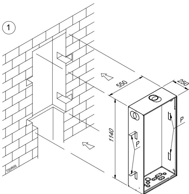
**Fig.1** - A seconda della profondità della parete ricavare un'nicchia o un'apertura delle dimensioni dell'unità da incasso e uno spazio sotto a questa per poter eseguire gli allacciamenti.
