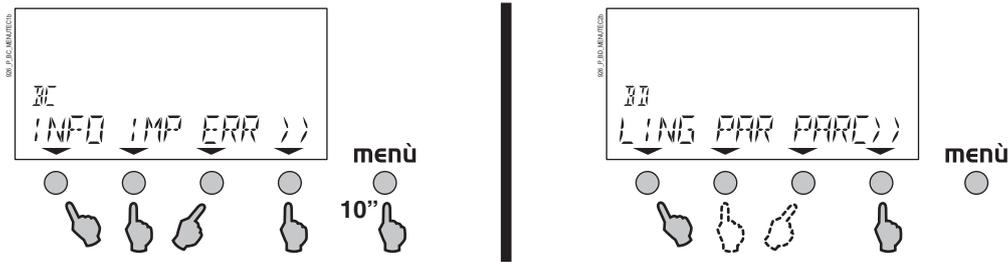
*Nota: il sottomenu PAR non è utilizzabile in questo modello di caldaia. Il sottomenu PARC è già stato descritto nel paragrafo "Programmazione delle regolazioni caldaia" e contiene i valori PARAMC da utilizzare nelle regolazioni della caldaia, operazioni già descritte nelle pagine precedenti.*
