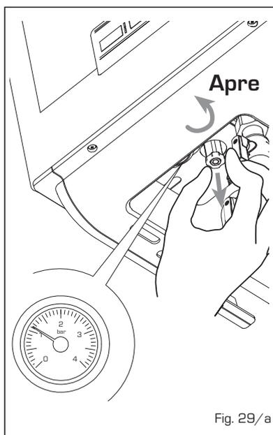
Se si rende necessario ripetere più volte la procedura di caricamento impianto, si consiglia di contattare il Servizio Tecnico di zona per verificare l'effettiva tenuta dell'impianto di riscaldamento (controllo di eventuali perdite).
