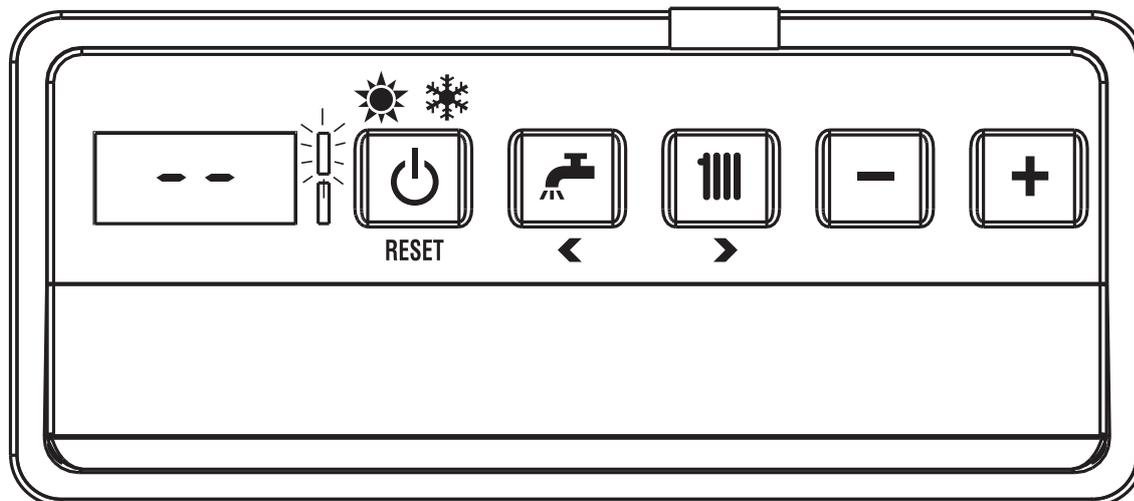
**ATTENZIONE:** per impostare le modalità di funzionamento sfiorare semplicemente i tasti. Quando la caldaia recepisce il comando il led verde si spegne per un breve istante. Se il PAR 5 viene disabilitato il display resta sempre illuminato.
