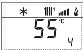
5. Visualizzazione temperatura sonda fumi
