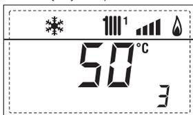
4. Visualizzazione temperatura sonda ausiliaria o sonda bollitore (SB)
