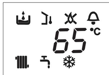
1 Visualizzatore digitale che segnala la temperatura di funzionamento e i codici anomalia
