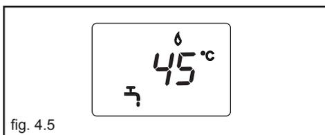
**Preriscaldamento** (acqua calda più veloce): ruotando la manopola regolazione temperatura acqua sanitaria (fig. 4.6) sul simbolo ☺ si attiva la funzione preriscaldamento, il visualizzatore (1 - fig. 3.1) mostra il simbolo **P** fisso. Riportare la manopola di regolazione temperatura acqua sanitaria nella posizione desiderata. Questa funzione permette di mantenere calda l'acqua contenuta nello scambiatore sanitario al fine di ridurre i tempi di attesa durante i prelievi.
