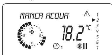
In caso di Blocco per mancanza di gas o per mancanza acqua è possibile procedere allo sblocco (dopo aver rimosso la causa del blocco) mediante la pressione contemporanea dei tasti:
