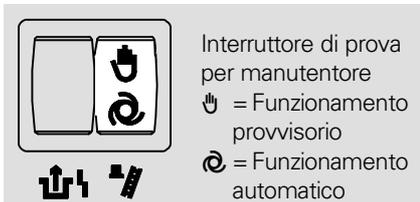
Per analisi dei gas di scarico con temperatura acqua di caldaia costante:
