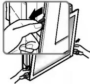
3. Spingere e chiudere la parte superiore del pannello frontale, quindi tirare la parte inferiore del pannello in avanti fino a fissarla.
