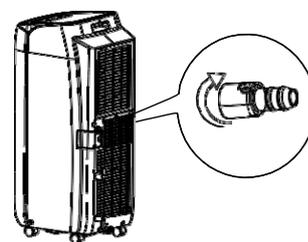
2. Avvitare il tubetto di connessione fornito nel package girandolo in senso orario.
