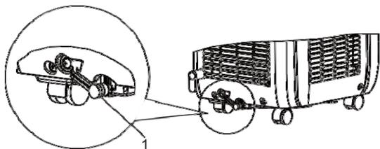
2. Installare la fascetta(2) sul retro a destra vicino al foro di drenaggio(1) con una vite(3).
