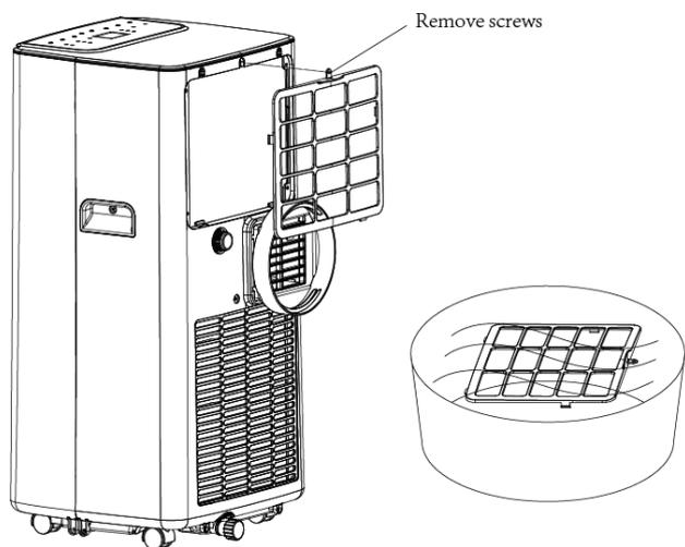
I filtri dell'aria devono essere controllato almeno una volta ogni due settimane di funzionamento. Il funzionamento con filtri sporchi o intasati causa sempre una diminuzione dell'efficienza del climatizzatore e può provocare inconvenienti gravi.
