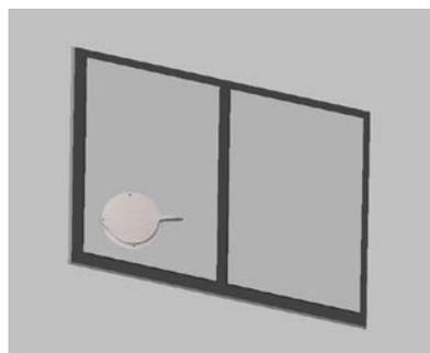
3. Inserire il raccordo circolare per kit oblò nel tubo flessibile retrattile e inserire il tubo flessibile retrattile con raccordo circolare nell'oblò privo del tappo.
