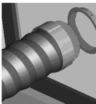
5. Inserire il tubo flessibile così montato sul retro del climatizzatore.
