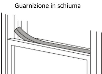
1. Tagliare su misura la guarnizione A (autoadesiva) e incollarla sul telaio, fig. 8. Poi tagliare su misura la guarnizione B e posarla sulla guarnizione A, fig. 9.
