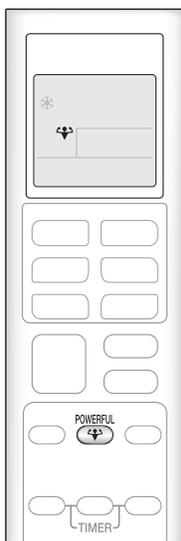
Il funzionamento POWERFUL porta rapidamente al massimo l'effetto del raffreddamento (riscaldamento) in qualsiasi modo funzionamento. Con questa modalità, il condizionatore d'aria funziona alla massima capacità.
