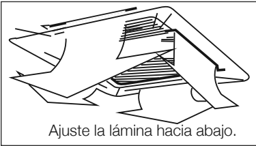
Figura 15 Funcionamiento de la calefacción
