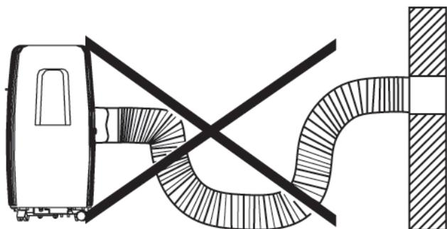
Fare in modo che il percorso del tubo sia il più possibile rettilineo (adattarne la lunghezza alla reale necessità) e che quindi non sia soggetto a curve brusche.
