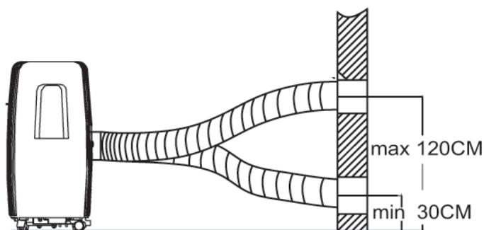
Esempio di montaggio corretto: in caso di montaggio permanente del tubo di espulsione dell'aria calda, il centro del foro a parete deve trovarsi ad un'altezza compresa tra 30 cm e 120 cm dal pavimento.
