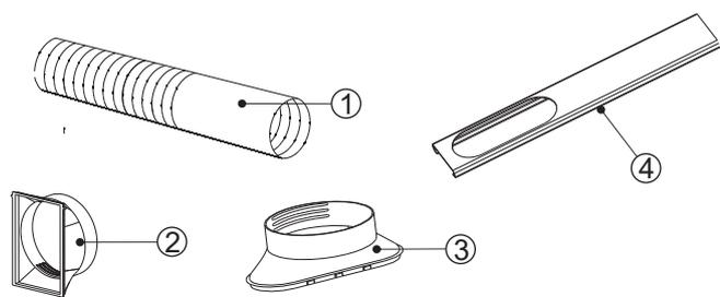
1 - Tubo flessibile per espulsione aria calda.
