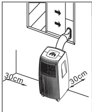
Collocare il condizionatore portatile in prossimità di una finestra, su un pavimento dalla superficie regolare e perfettamente orizzontale.
