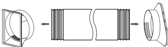
1) Estendere il tubo flessibile alle estremità ed innestare i due terminali tramite azione di avvitamento.
