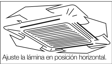
Figura 14 Funcionamiento de la refrigeración
