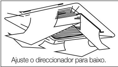
Fig. 15 Função de aquecimento
