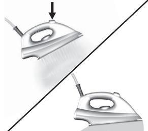
**9. Wenn die Dampfanzeige leuchtet, halten Sie den Dampfknopf etwa eine Minute gedrückt, um Dampf zu erzeugen, und halten Sie ihn dann eine weitere Minute gedrückt, um das Dampferzeugungssystem zu reinigen. Bügeln Sie ein altes Handtuch, um sicherzustellen, dass Rückstände innerhalb des Bügeleisens nicht auf die Wäsche übertragen werden. Wenn nötig, wischen Sie die Grundplatte mit einem leicht befeuchteten Tuch ab.**
