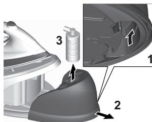
**1. Entfernen Sie den Wassertank,** indem Sie den Schlitz an der Unterseite greifen und ihn sanft von der Basis-Einheit wegziehen. Legern Sie den Wassertank an einer sicheren Stelle, während Sie die Entkalker-Patrone austauschen.
