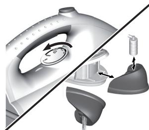
6. Stellen Sie die Temperatur-Wahlscheibe zurück auf die minimale Einstellung. Schalten Sie dann die Dampfstation ab und trennen Sie sie von der Stromversorgung. **Leeren Sie den Wassertank** und lassen Sie das Bügeleisen vor der Lagerung vollständig abkühlen.
