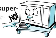
**Installare il forno lontano** da fonti di calore. Per consentire una ventilazione sufficiente, lasciare sopra il forno uno spazio di almeno 20 cm. Assicurarsi che lo spazio lasciato sotto, sopra e intorno al forno consenta la circolazione di un flusso d'aria adeguato.
