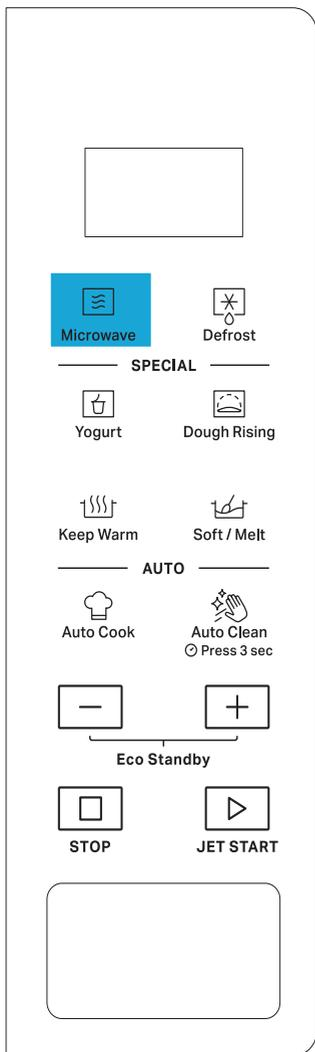
**PER CUCINARE CON** potenza microonde individualmente, premere ripetutamente il pulsante Microwave (Microonde) per selezionare un livello di potenza di cottura, quindi premere il pulsante +/- per impostare il tempo di cottura desiderato. Il tempo di cottura più lungo è 90 minuti.
