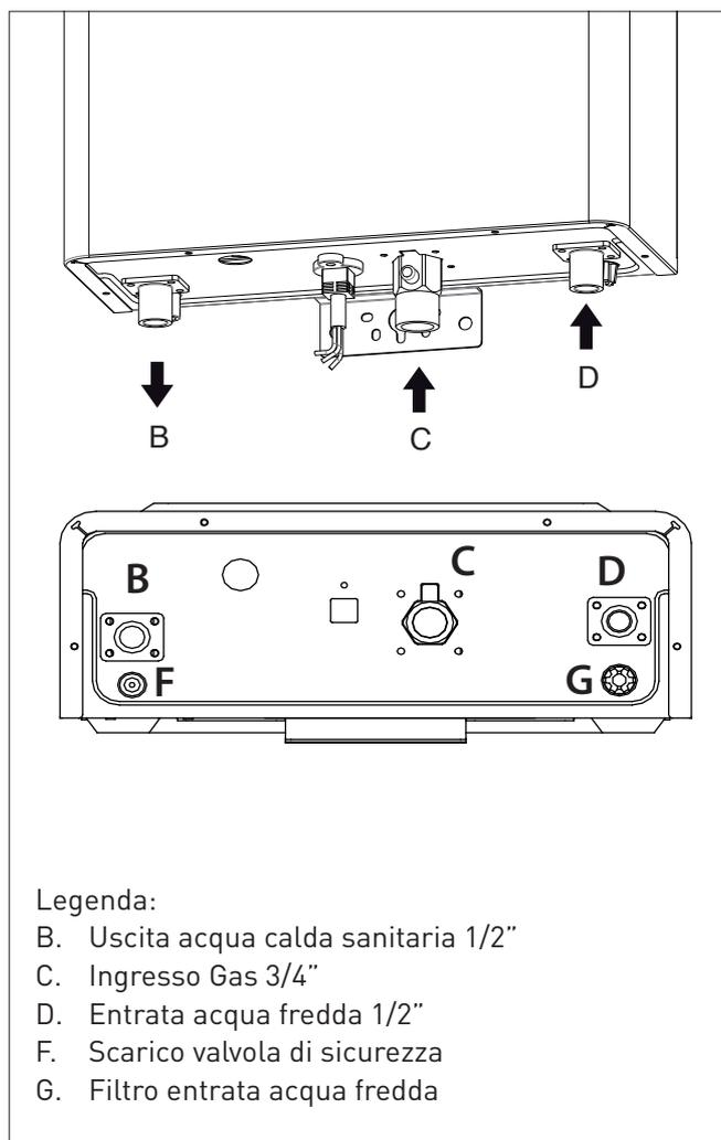
L'apparecchio è provvisto di un filtro "G" sull'ingresso dell'acqua fredda. In caso di sporcizia nell'impianto idrico provvedere periodicamente alla pulizia dello stesso.
