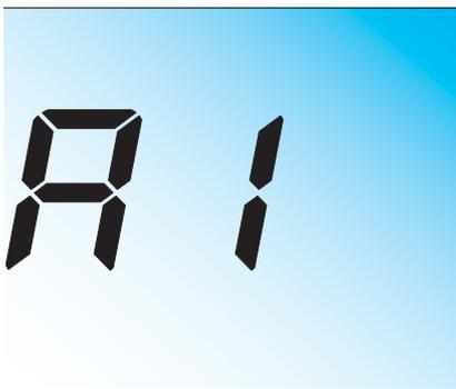
Se l'apparecchio segnalerà ancora il codice d'errore spegnere l'apparecchio, chiudere il rubinetto del gas, portare l'interruttore elettrico esterno in posizione di OFF e contattare un tecnico qualificato
