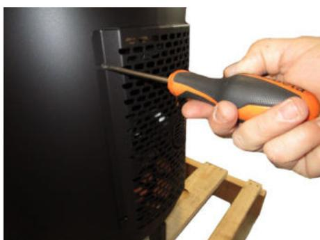
Fig. 25 - Rimozione carter
