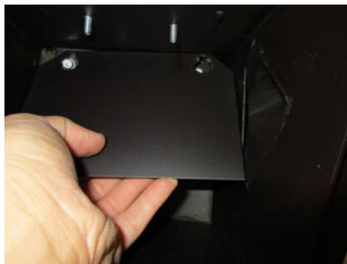
Fig. 97 - Rimozione deviatore fumi
