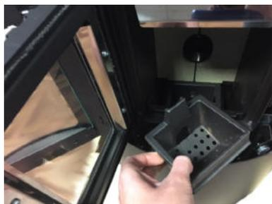
Fig. 86 - Rimozione braciere
