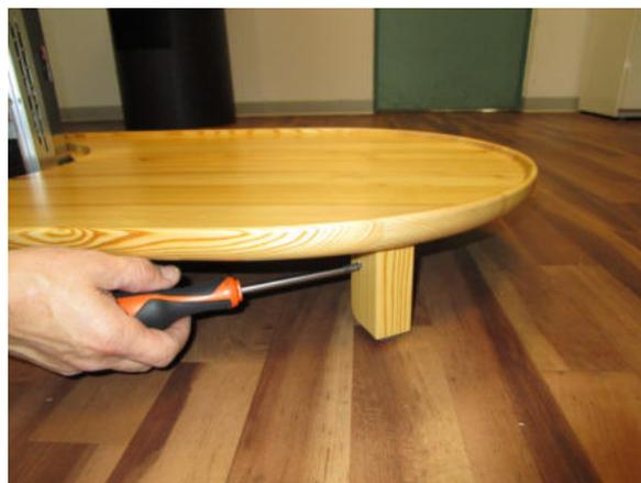
Fig. 56 - Fissaggio piedini
