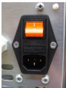
Fig. 66 - Presa elettrica con interruttore generale
