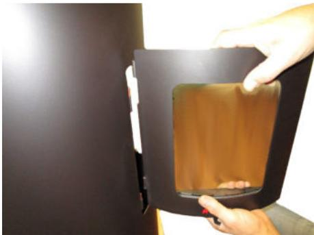
**Fig. 27 - Rimozione porta**
