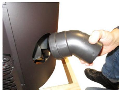
Fig. 24 - Rimozione curva
