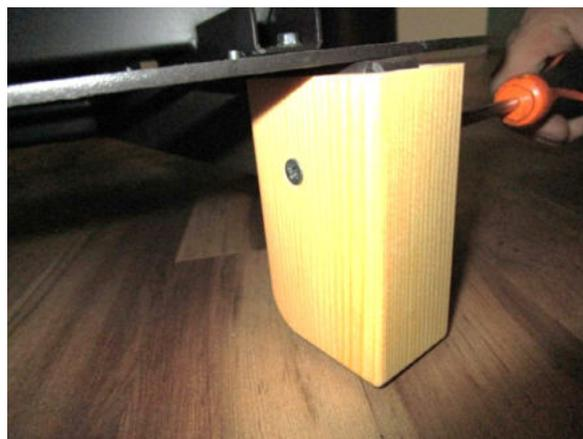
Fig. 44 - Fissaggio piedini
