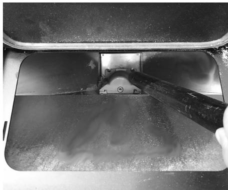
**Fig. 25 - Pulizia serbatoio e coclea**
