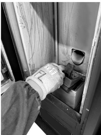
**Fig. 21 - Rimozione braciere**
