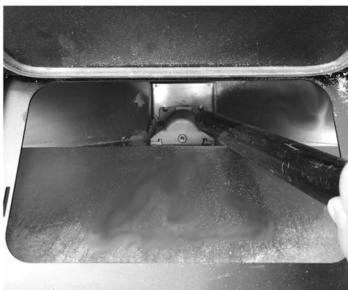
Fig. 25 - Pulizia serbatoio e coclea
