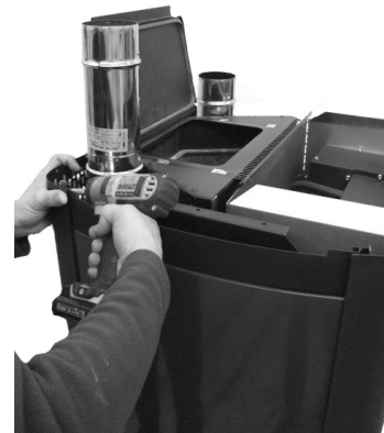
Fig. 47 - Riposizionamento profili curvi superiori
