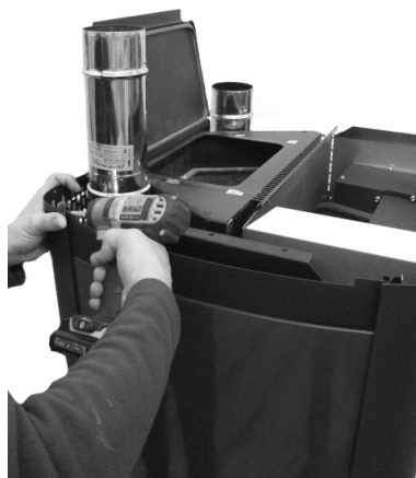
Fig. 91 - Rimozione profili curvi superiori
