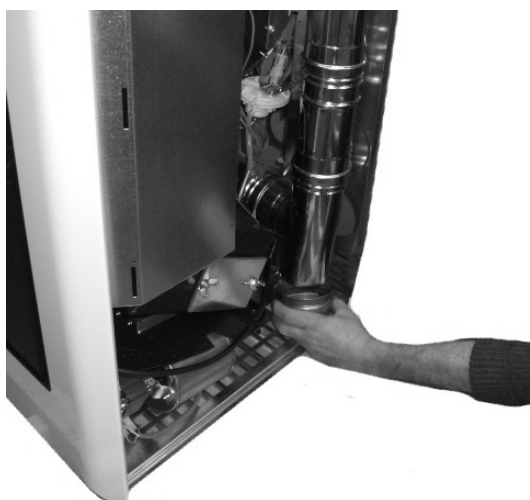
Fig. 102 - Pulizia canale da fumo
