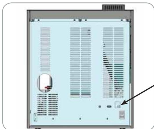
Posizione dell'interruttore, protetto dal cappuccio avvitabile, del termostato a riarmo di sicurezza posto sul retro della stufa.
