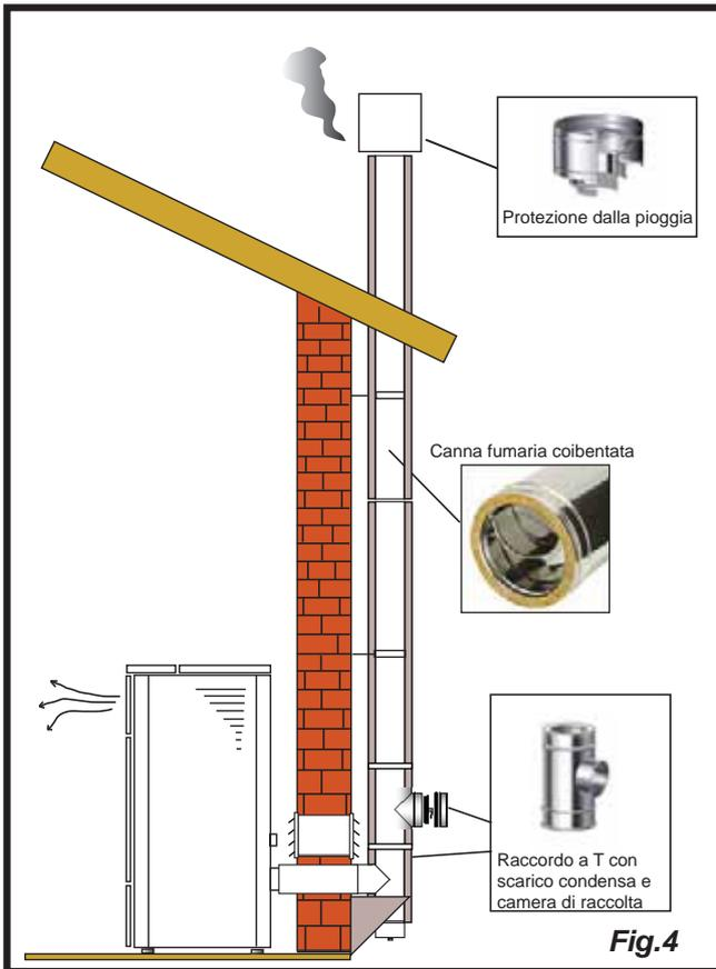
Questo tipo di installazione (Vedi Fig.4) necessita di canna fumaria coibentata, in quanto tutto il condotto fumi è stato montato all'esterno dell'abitazione.
