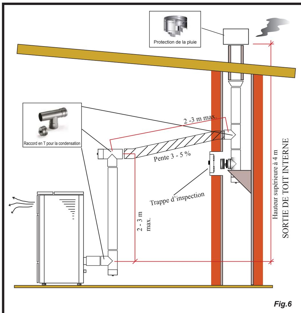
Ce type d'installation (voir la Fig.6) requiert un tronçon horizontal pour se raccorder à une sortie de toit déjà existante. Respecter les pentes indiquées sur la figure de manière à réduire le dépôt des cendres dans le tronçon du tuyau horizontal. Un raccord de type en « T » doté d'un bouchon d'inspection a été monté dans la partie inférieure et à l'entrée de la sortie de toit.
