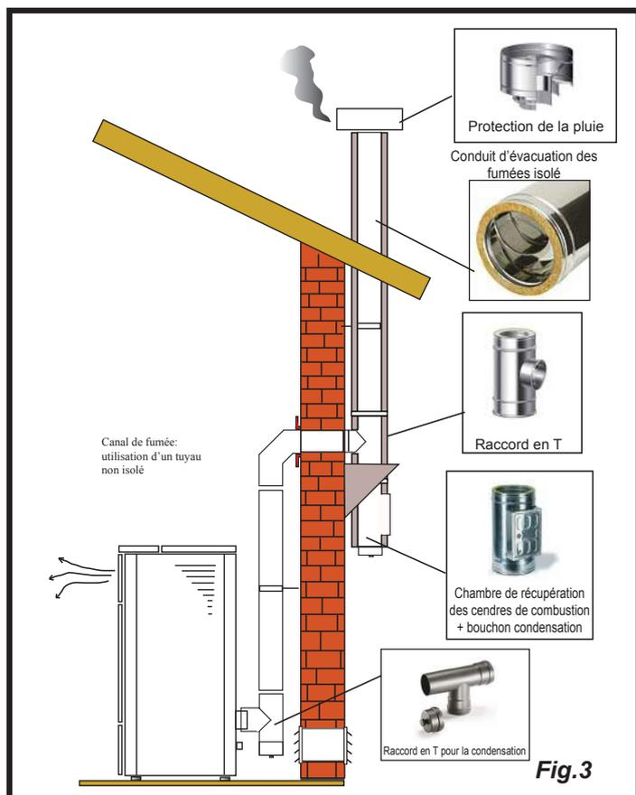
Il est possible d'utiliser un conduit d'évacuation des fumées existant ou une gaine technique au moyen d'une canalisation. Pour ce type d'installation, il faut respecter les normes concernant les systèmes d'évacuation des fumées canalisés. Un raccord de type en « T » a été monté dans la partie inférieure de la sortie de toit à l'intérieur de l'habitation ; un autre a été monté à l'extérieur de manière à ce que le tronçon à l'extérieur puisse être inspecté.
