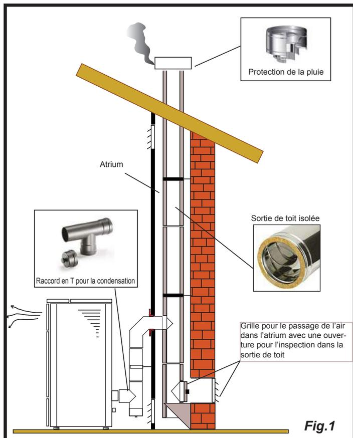
Ce type d'installation (voir la Fig. 1) exige une sortie de toit isolée bien que l'ensemble du conduit soit monté à l'intérieur de l'habitation. La structure doit en outre être insérée dans un atrium convenablement ventilé.
