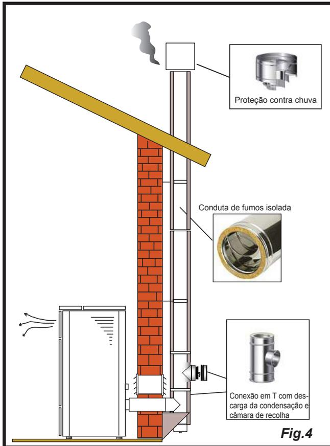
Este tipo de instalação (Ver Fig.4) requer conduta de fumos isolada, pois o tubo foi inteiramente montado na parte externa da residência.
