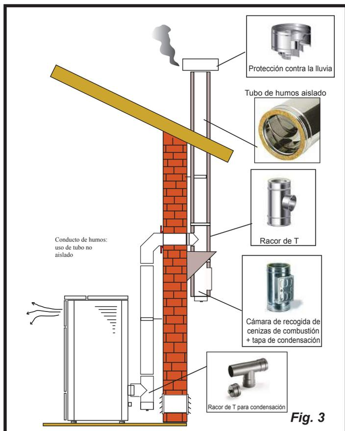
Es posible aprovechar un tubo de humos o un canal mediante un conducto. Para este tipo de instalación es necesario respetar las normas relativas a los sistemas de evacuación de humo en conductos. En la parte inferior del tubo de humos ubicado dentro de la casa se ha instalado un conector tipo "T" con tapa de inspección; en el exterior se ha instalado otro, para que el tramo externo se pueda inspeccionar.
