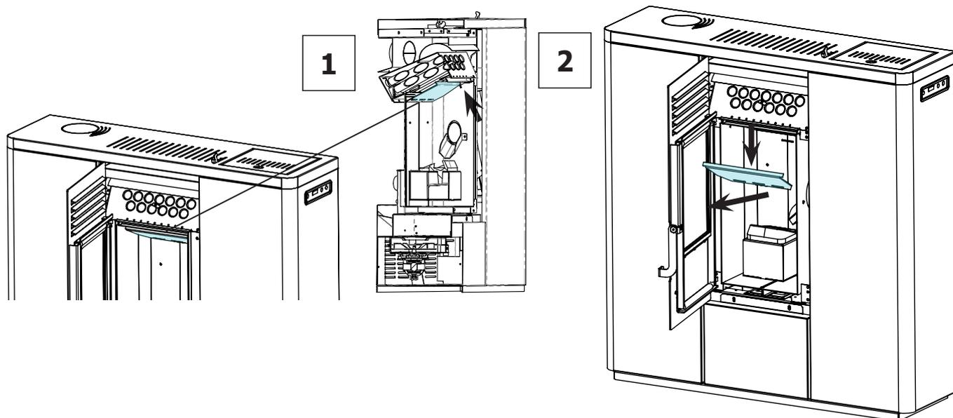
**Nettoyage de l'échangeur à faisceau tubulaire:**
