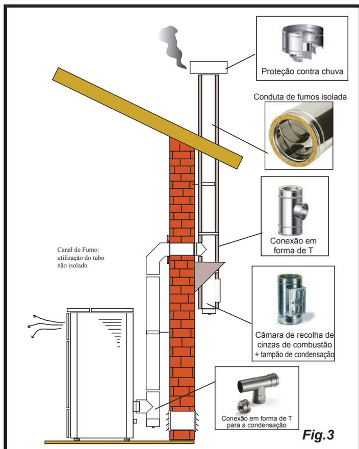
É possível utilizar uma conduta de fumos existente ou um poço de ventilação por meio de encamisamento. Para este tipo de instalação é necessário respeitar as normas referentes aos sistemas de evacuação de fumos encamisados. Na parte inferior da conduta de fumos na parte interna da casa foi montada uma conexão de tipo "T" com tampão de inspeção; na parte externa foi montada outra conexão do mesmo tipo de modo que o segmento externo possa ser inspecionado.
