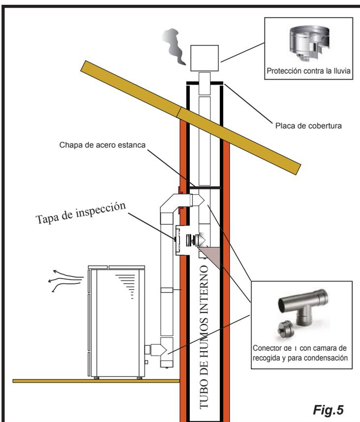
Este tipo de instalación (Vea la Fig.5) no necesita un tubo de humos aislado, ya que una parte del canal de humos se ha instalado dentro del local y otra parte se encuentra dentro del tubo de humos ya existente. En la parte inferior de la estufa se ha instalado un conector tipo "T" con tapa de inspección, como en la parte interna del tubo de humos.
