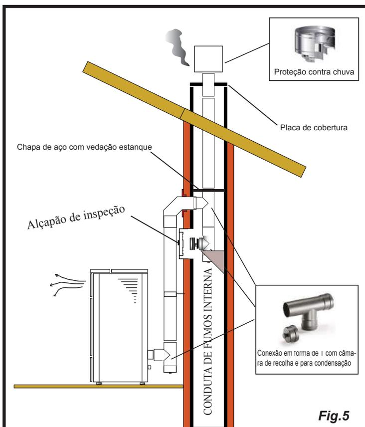
Este tipo de instalação (Ver a Fig.5) não requer conduta de fumos isolada, pois uma parte do tubo de fumos está montada na parte interna da residência, e a outra parte está situada na parte interna de uma conduta de fumos preexistente.
