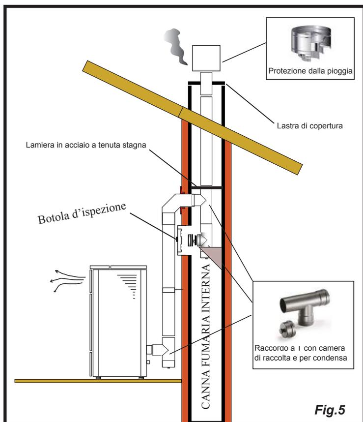
E' possibile sfruttare una canna fumaria esistente od un cavedio mediante intubamento. Per questo tipo di installazione è necessario rispettare le norme riguardanti i sistemi di evacuazione fumo intubati. Nella parte inferiore della canna fumaria, è stato montato un raccordo di tipo "T" con tappo di ispezione.
