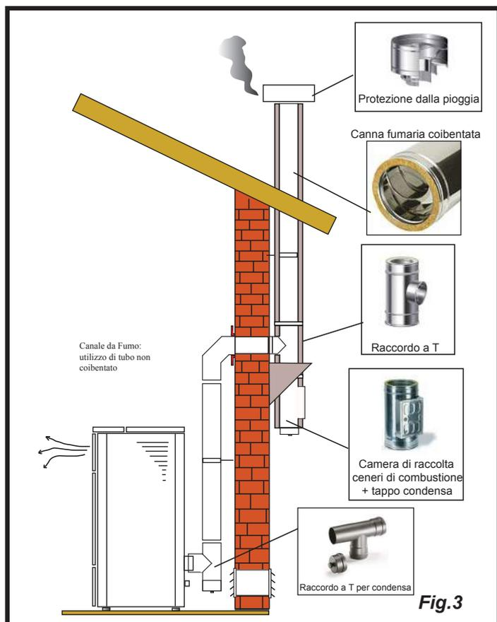
Questo tipo di installazione (Vedi Fig.3) non necessita di canale da fumo coibentato per il tratto interno dell'abitazione, mentre per il tratto posto all'esterno è obbligatorio utilizzare una tubazione coibentata. Nella parte inferiore della canna fumaria all'interno della casa è stato montato un raccordo di tipo "T" con tappo di ispezione; esternamente ne è stato montato un'altro, in modo che il tratto esterno sia ispezionabile.
