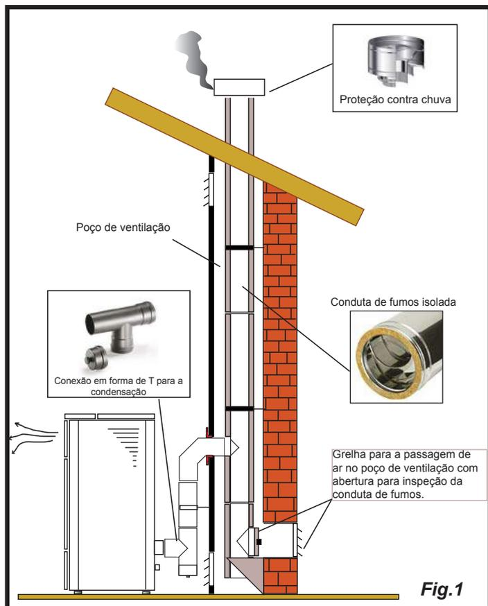
Este tipo de instalação (Ver Fig.1) requer conduta de fumos isolada mesmo se o tubo for inteiramente montado na parte interna da residência. Além disso, a estrutura deve estar inserida em um poço de ventilação devidamente ventilado.
