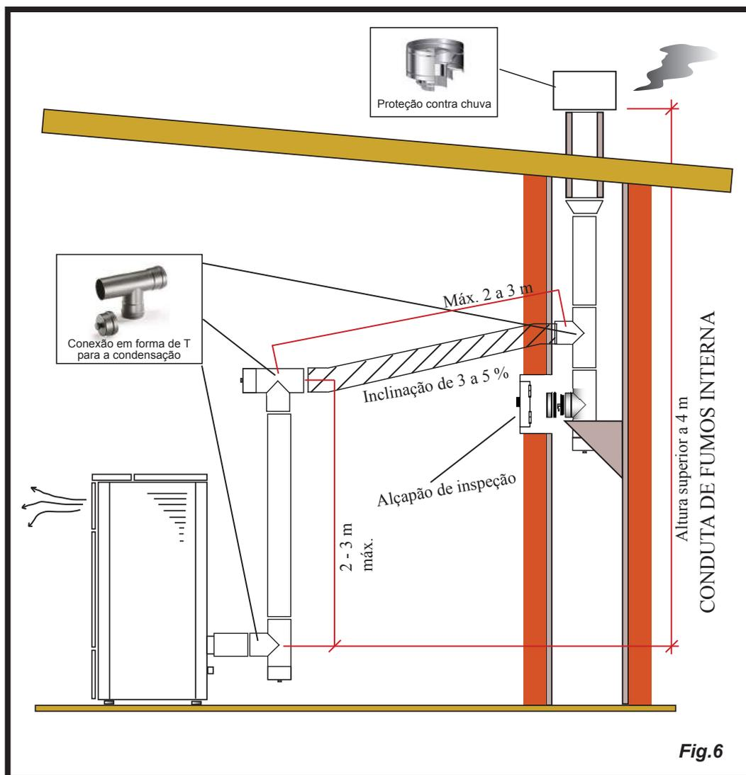
Este tipo de instalação (Ver a Fig.6) requer um segmento horizontal para conectar-se a uma conduta de fumos preexistente. Respeitar as inclinações indicadas na figura a fim de reduzir o depósito de cinzas no segmento de tubo horizontal. Na parte inferior da conduta de fumos foi montada uma conexão de tipo "T" com tampão de inspeção, tal como na entrada da conduta de fumos.
