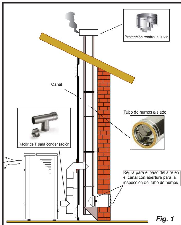
Este tipo de instalación (Vea Fig.1) necesita un tubo de humos aislado aunque todo el conducto se instale dentro del local. Además, la estructura debe colocarse en un canal ventilado de manera adecuada.
