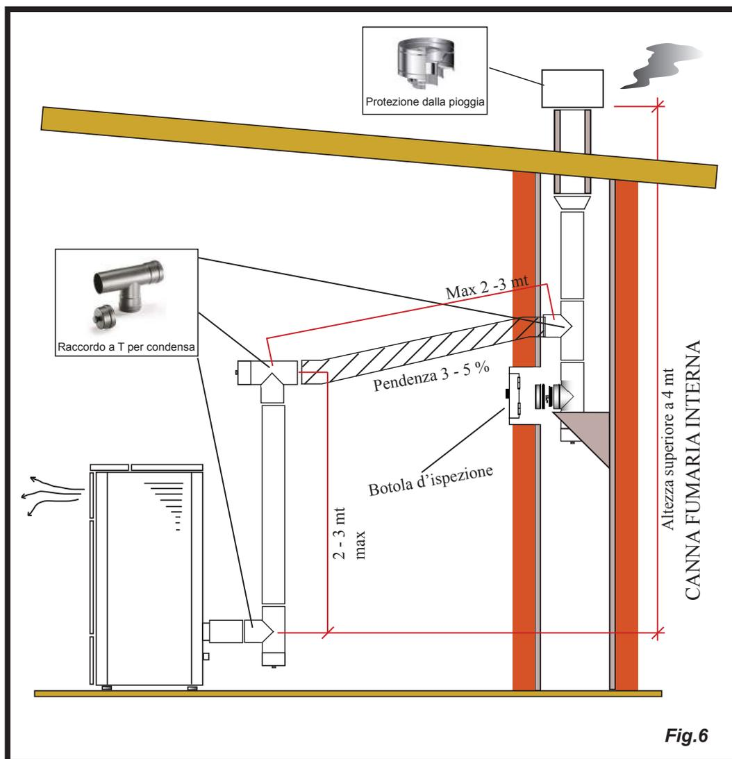
Questo tipo di installazione (Vedi Fig.6) necessita di un tratto orizzontale per collegarsi ad una canna fumaria già esistente. Rispettare le pendenze indicate in figura, in modo da ridurre il deposito della cenere nel tratto di tubo orizzontale. Nella parte inferiore della canna fumaria è stato montato un raccordo di tipo "T" con tappo di ispezione, così come all'imbocco della canna fumaria.
