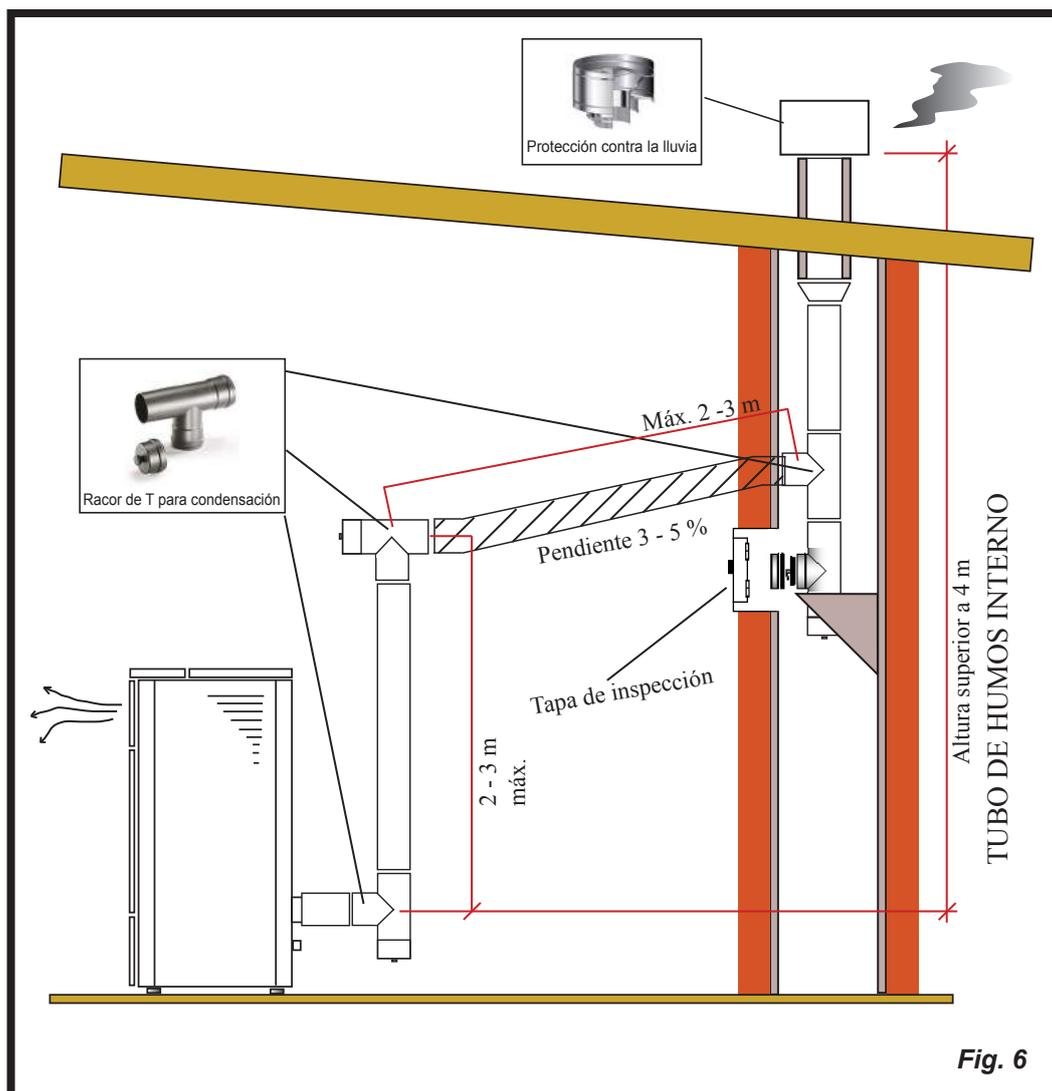
Este tipo de instalación (Vea la Fig. 6) necesita un tramo horizontal para conectarse al tubo de humos ya existente. Respete las pendientes indicadas en la figura para poder reducir el depósito de cenizas en el tramo de tubo horizontal. En la parte inferior del tubo de humos se ha instalado un conector tipo "T" con tapa de inspección, así como en la entrada del tubo de humos.
