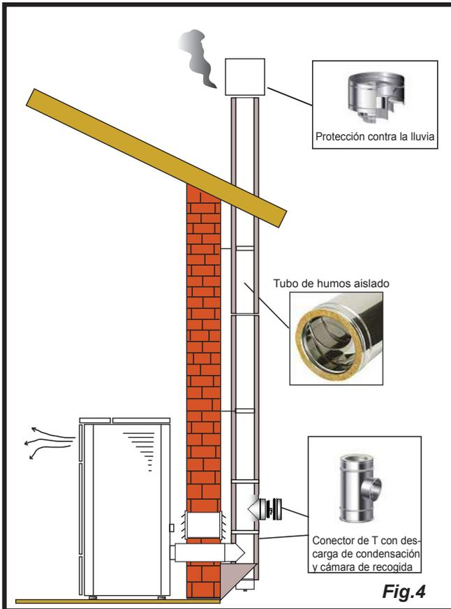
Este tipo de instalación (Vea Fig.4) necesita un tubo de humos aislado ya que todo el conducto de humos se ha instalado en el exterior del local.
