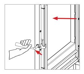
Con un pennello a setole morbide, eliminare il pulviscolo di combustione, facendolo cadere sul piano sottostante.
