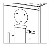
Smontare il fianco posteriore con la chiave da 8 (viti M5), prelevare dalla scatola del kit il termostato a contatto e collegarlo sul fianco del condotto aria con un cacciavite a "+".
