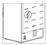
Asportare il preforato posto nella parte posteriore del prodotto e, seguendo lo schema dei fori (vedi freccie), fissare il kit di canalizzazione alla piastra posteriore interna con la chiave da 8 (viti M5).
