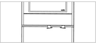
La combustione è efficiente e pulita quando la fiamma si presenta con una colorazione giallo chiaro. Se la fiamma tende al rosso oppure si riscontra del fumo nero in camera di combustione, si deve agire sulla valvola in centro al prodotto, per aumentare leggermente l'aria secondaria. È necessario un primo periodo di utilizzo per apprendere come regolare correttamente la combustione.
