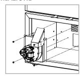
Seguendo lo schema dei fori (vedi frecce), fissare il kit ventilazione alla piastra posteriore interna con la chiave da 8 (viti M5).
