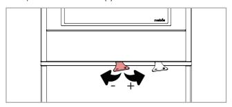
L'indicazione ideale per verificare la corretta combustione è il colore della fiamma. Se la colorazione della fiamma tende a scurire, creando fuliggine in camera di combustione e sbuffi neri di fumo, si tratta di cattiva combustione per mancanza di aria. Sarà pertanto necessario aggiungere aria secondaria
