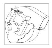
Asportare il preforato per permettere il passaggio del cablaggio dal termostato a contatto al ventilatore aria (vedere schema elettrico in fondo al manuale).
