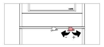
La maniglia di comando in centro è l'aria secondaria e va usata per controllare la combustione quando la stufa è in funzione. La massima apertura si ha quando viene spostata verso destra (+), mentre si riduce quando viene spostata a sinistra (-).
