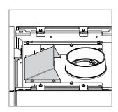
Sollevare il top in ghisa e fissare il convogliatore dell'aria con la chiave da 8 (viti M5).
