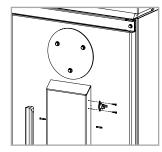
Smontare il fianco posteriore con la chiave da 8 (viti M5), prelevare dalla scatola del kit il termostato a contatto e collegarlo sul fianco del condotto aria con un cacciavite a "+".
