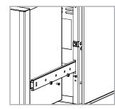
Per i modelli con il cassetto, prima di installare il kit, è necessario asportare il cassetto agendo sulle guide con la chiave da 2,5 (viti M4).
