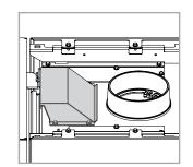
Sollevare il top in ghisa e fissare il convogliatore dell'aria con la chiave da 8 (viti M5).
