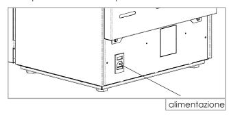
E' obbligatorio che l'impianto sia provvisto di messa a terra e di interruttore differenziale come da leggi vigenti. Inoltre assicurarsi che la presa sia compatibile con la tipologia di spina presente sul cavo di alimentazione adoperato.
