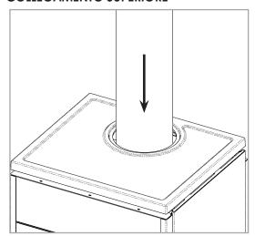
ATTENZIONE AL TRATTO DEL CANALE DA FUMO CHE DEVE RESISTERE A TEMPERATURE CHE POSSONO ARRIVARE FACILMENTE A 600°C.
