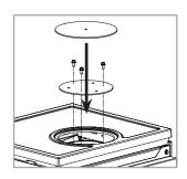
Con le 3 viti da M5, fissare il collare dove in precedenza è stato rimosso il tappo e collegare il tratto orizzontale del canale da fumo;
