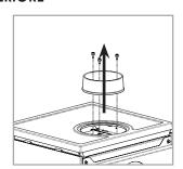
Asportare il preforato posteriore per accedere e rimuovere il tappo, agendo sulle 3 viti mediante la chiave esagonale da 8. Ripetere l'operazione per rimuovere il collare in ghisa fissato sulla testata del prodotto.
