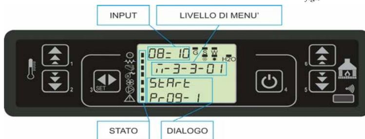
In **figura 4** è descritta la disposizione dei messaggi in fase di programmazione o impostazione dei parametri operativi. In particolare:
