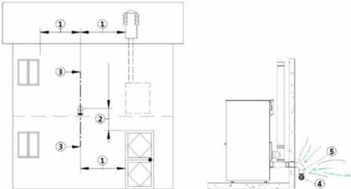
**Fig. 7 - Presa d'aria per installazione a camera stagna**
