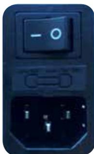
Fig. 16 - Presa elettrica con interruttore generale
